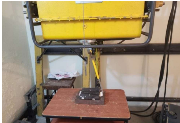
Figura 2.9 Posicionamiento de la placa para el ensayo radiográfico. (Fuente: propia)
