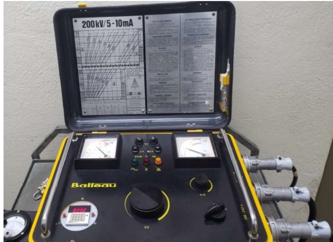
Figura 2.10. Consola de comando durante el ensayo.
