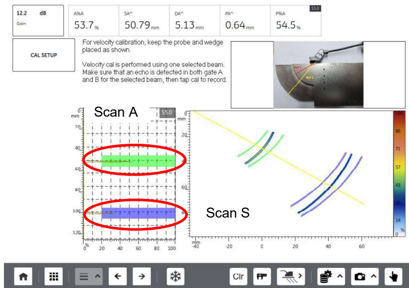
Figura 2.16. Calibración de velocidad de ultrasonido.
