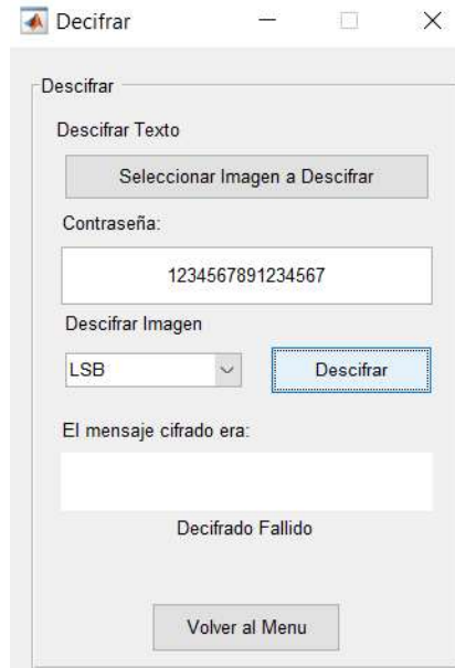
Figura 3.14. Descifrado fallido por ubicación del bit para la estegoimagen en Cifrar Texto En Imagen.
