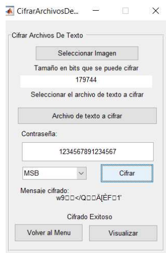
Figura 3.17. Correcta ejecución del módulo Cifrar Archivo de Texto En Imagen, contraseña ingresada, bit MSB
