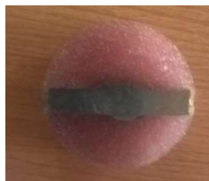
Figura 2.35. Muestra metalográfica montada. Fuente: (Propia)
