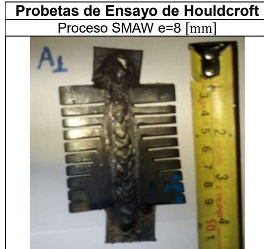
Figura 2.12. Inspección visual a la probeta de Houldcroft. Fuente: Propia
