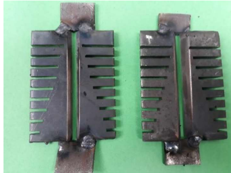
Figura 2.9. Preparación de Probetas para ensayo de Houldcroft. Fuente: (Propia)
