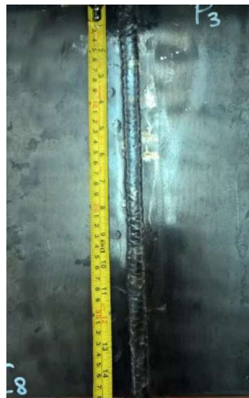
Figura 2.27. Probeta lista para ensayar. Fuente: (Propia)
