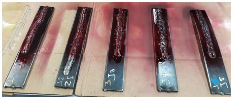
Figura 2.16. Aplicación del Líquido Penetrante. Fuente: (Propia)
