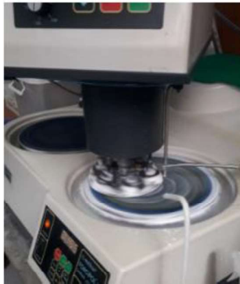
Figura 2.36. Muestra metalográfica siendo pulida. Fuente: (Propia)
