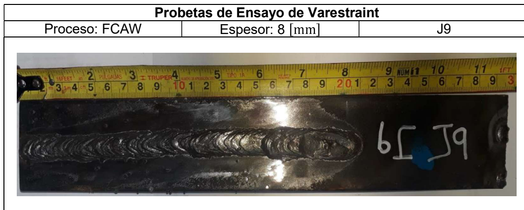
Figura 2.13. Inspección visual a la probeta de Varestaint. Fuente: Propia
