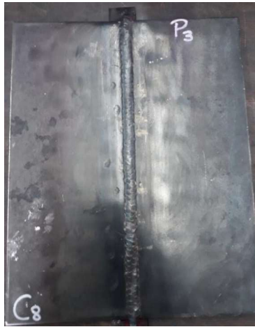
Figura 2.26. Probeta lista después de realizar la limpieza. Fuente: (Propia)
