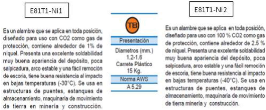
Figura 1.8. Características del electrodo para el proceso FCAW.. Fuente: (soldexa, 2015)
