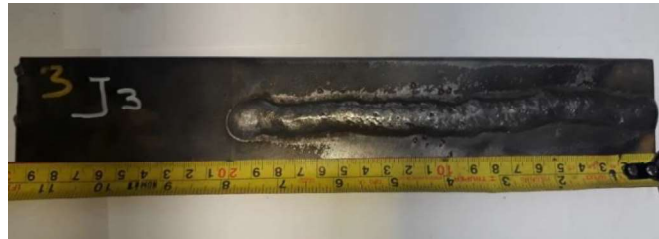
Figura 2.10. Cordón de Soldadura proceso FCAW. Ensayo Varestraint. Fuente: (Propia)
