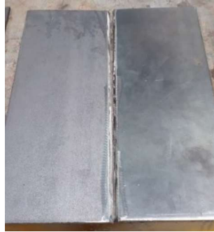
Figura 2.21. Bisel a 60°, acero ASTM A36. Fuente: (Propia)
