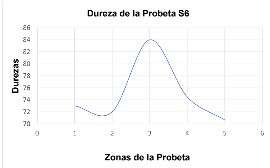
Figura 3.9. Esquema de dureza en la zona transversal de la probeta S6. Fuente: (Propia)
