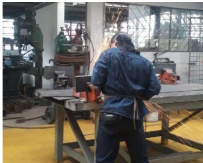
Figura 2.20. Preparación de juntas.
