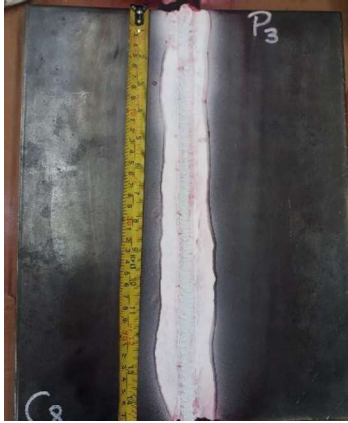
Figura 2.28. Aplicación del Revelador. Fuente: (Propia)
