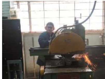
Figura 2.34. Corte de las Probetas. Fuente: (Propia)
