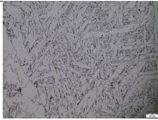
Micrografía del material de aporte con ataque químico, ferrita acicular con perlita fina esferoidal, 500X
