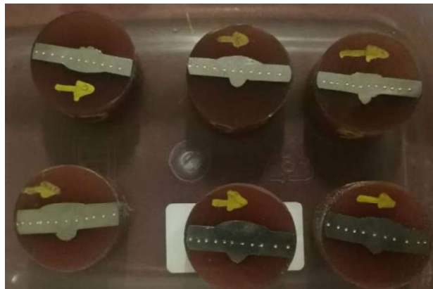
Figura 2.40. Probetas realizadas la prueba de dureza. Fuente: (Propia)
