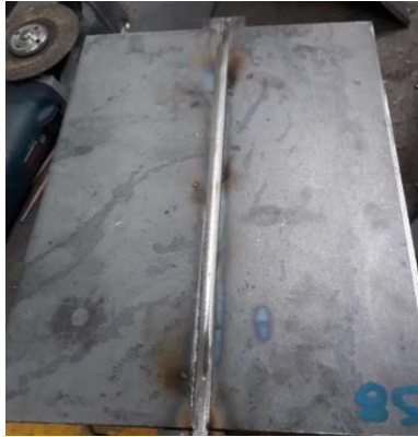
Figura 2.24. Cordón de Soldadura SMAW e=8 [mm]. Fuente: (Propia)
