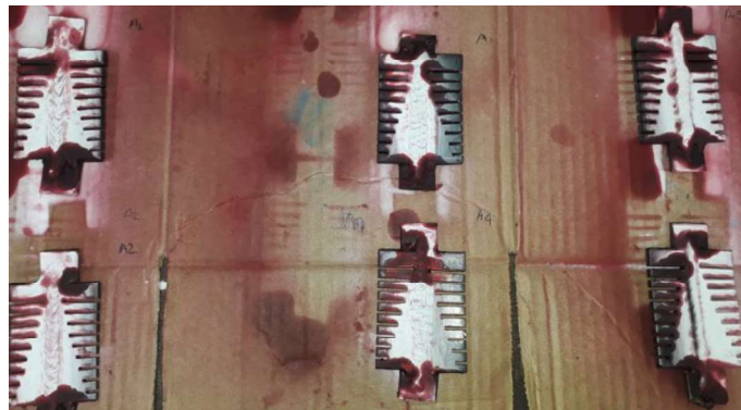
Figura 2.18. Aplicación del Revelador a probetas de Ensayo de Houldcroft. Fuente: (Propia)
