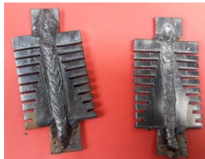
Figura 2.11. Cordón de Soldadura proceso SMAW, Ensayo Houldcroft. Fuente: (Propia)
