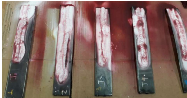
Figura 2.17. Aplicación del Revelador a probetas de Ensayo Vareststraint. Fuente: (Propia)
