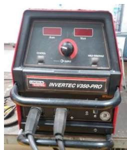
Figura 2.6. (a) Equipo de Soldadura FCAW y (b) Equipo de Soldadura SMAW. Fuente: Propia
