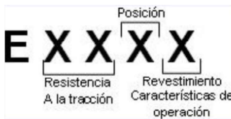
Figura 1.5. Sistema de Clasificación AWS A5.5 y A5.1. Fuente: (mecanica, 2011)
