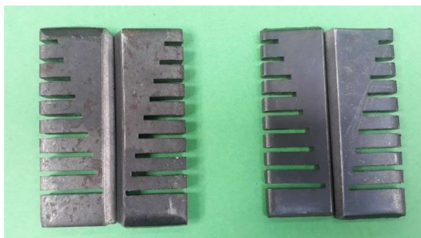
Figura 2.5. Probeta para ensayo de Houldcroft, bisel a 60° acero A36. Fuente: Propia
