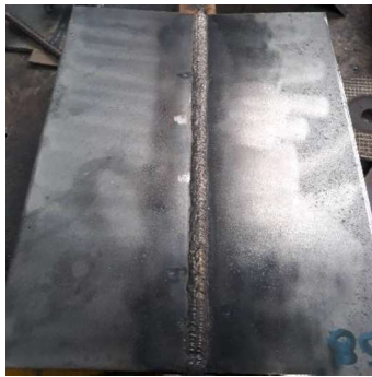
Figura 2.25. Limpieza del cordón. Fuente: (Propia)
