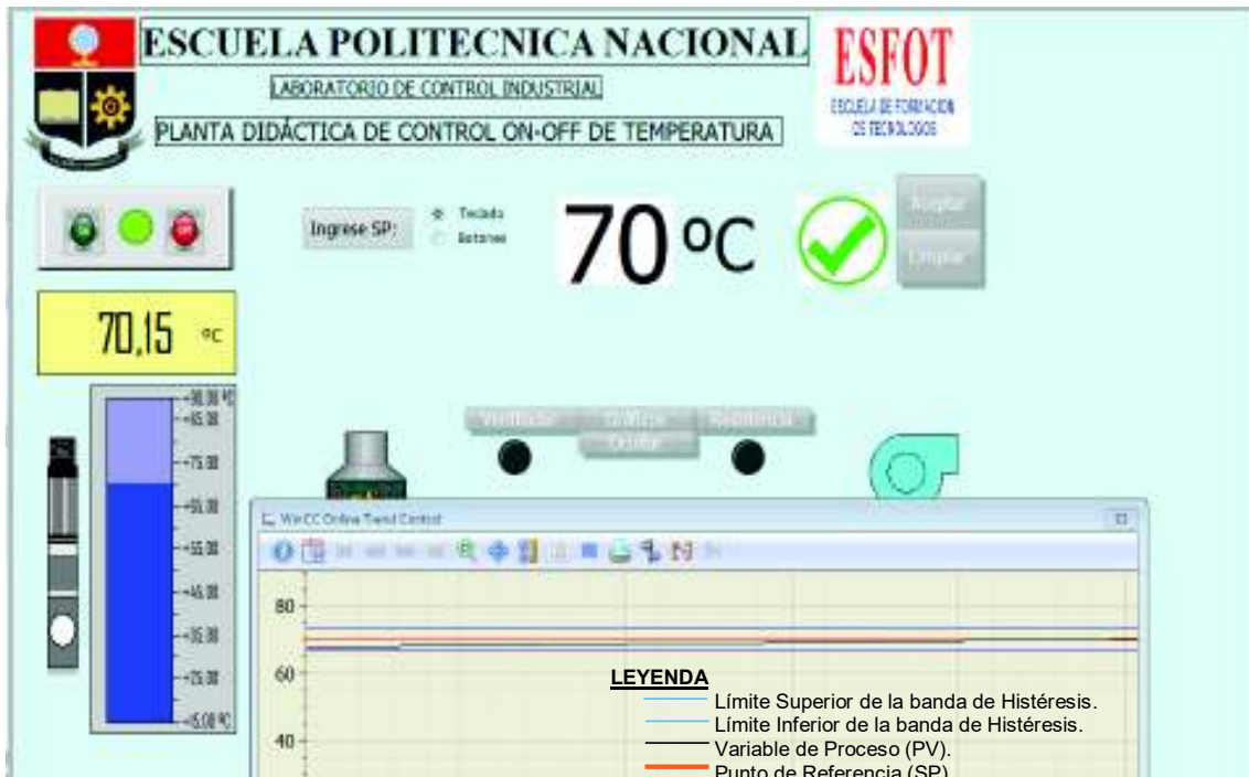
Figura 3. 74 – Control en tiempo real de la PV con un Set Point de 70° (C).
