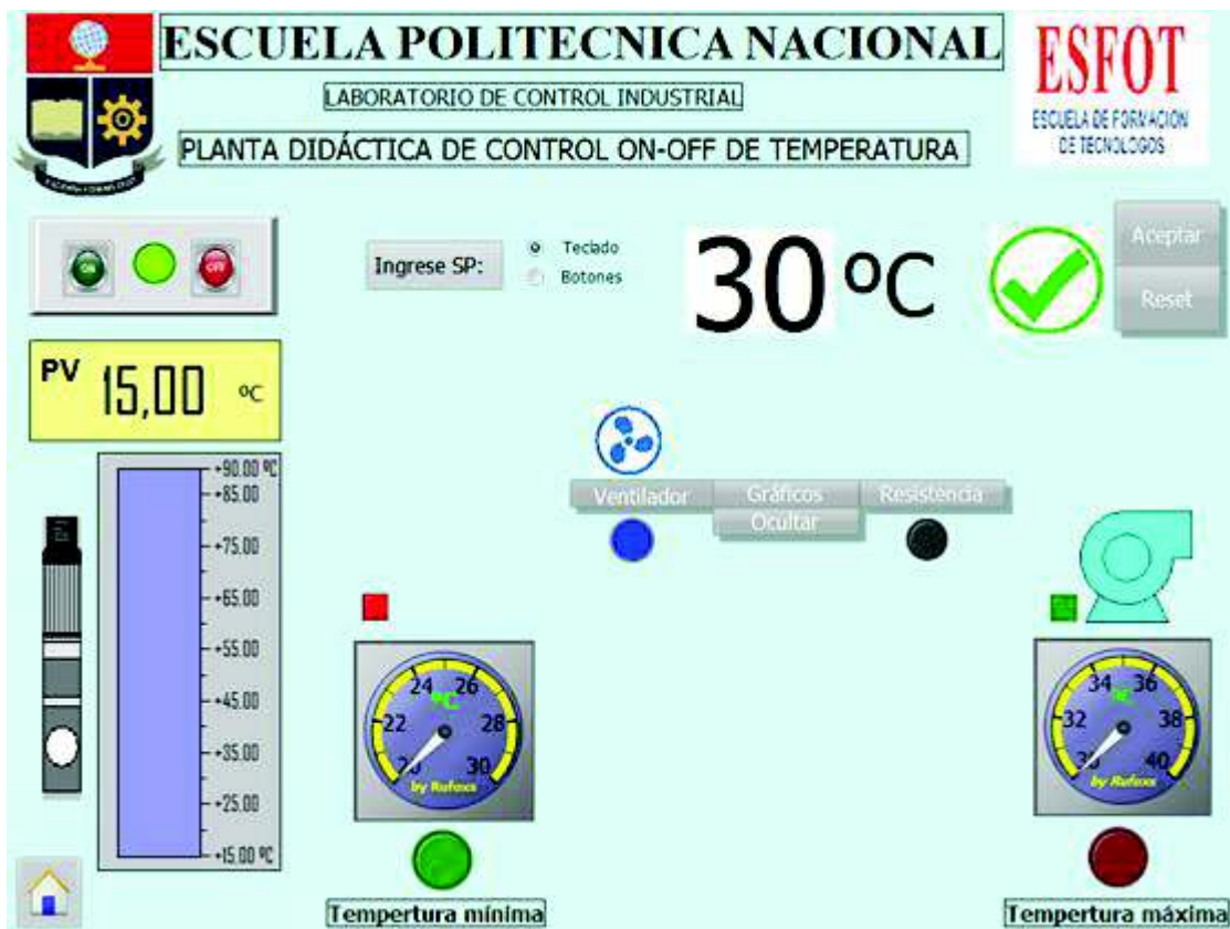
Figura 3. 36 – Pantalla del proceso de control
