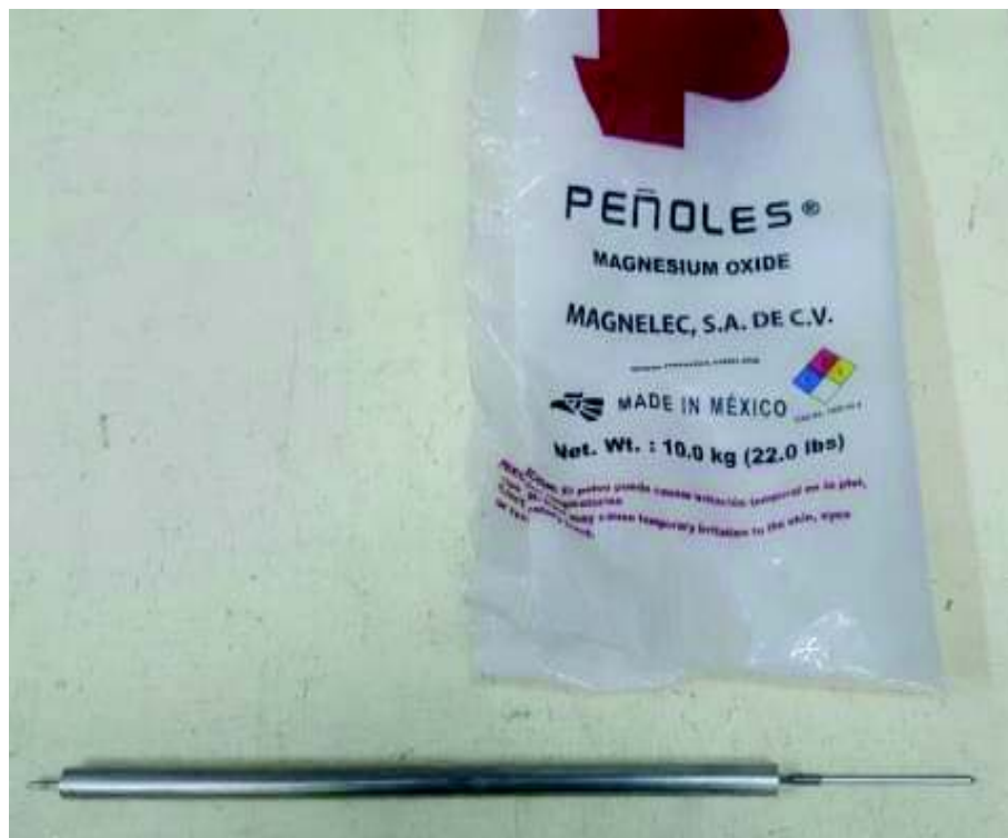
Figura 3. 59 – Relleno de tubo de acero con Óxido de Magnesio
