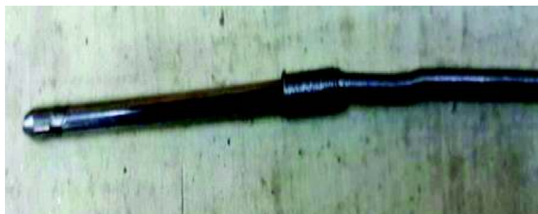
Figura 3. 57 – Montaje del alambre CuNi2 en punteras
