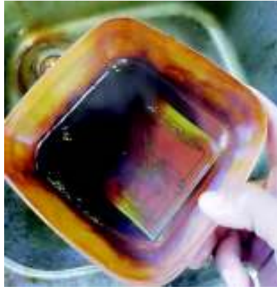
Figura 3. 46 – Inmersión de la placa en ácido férrico.
