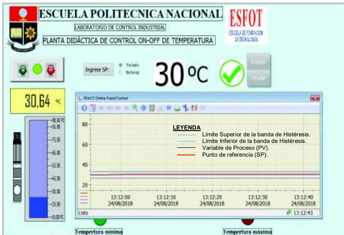
Figura 3. 73 – Control en tiempo real de la PV con un Set Point de 30° (C).
