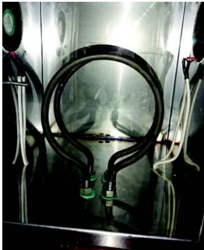
Figura 3. 61 – Montaje de las resistencias
