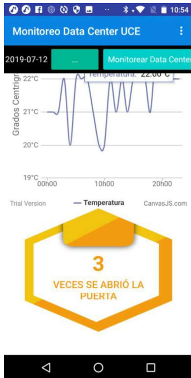
Figura 3.8. Captura de pantalla de la aplicación mostrando el conteo de las veces que la puerta del UPC principal es abierta.
