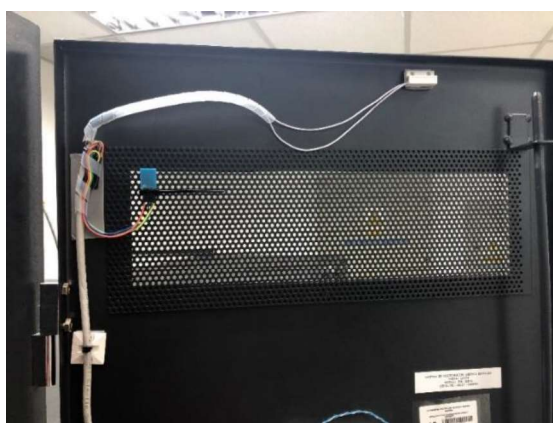
Figura 3.11. Sensores de Temperatura y Reed Switch .
