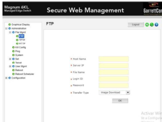
Figura 2.26. Configuración de FTP en el switch 1 de la subestación EL RETORNO
