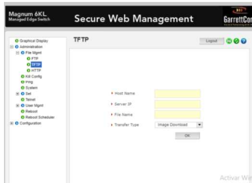
Figura 2.27. Configuración de TFTP en el switch 1 de la subestación EL RETORNO
