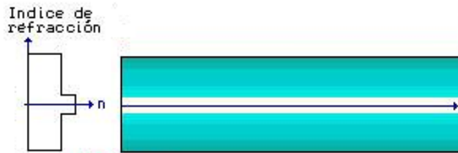
Figura 1.9. Propagación en una fibra monomodo de índice escalonado [10]
