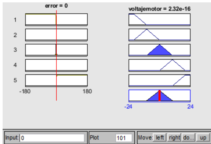
Figura 2.28 – Reglas de la Lógica Difusa en Matlab para el colector solar alineado al sol.
