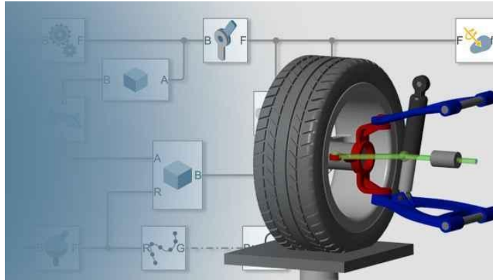
Figura 1.21 – Modelado de un neumático en 3D con controladores, entradas y salidas en Simscape Multibody (Matlab-Simulink).
