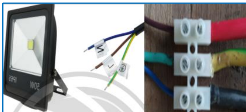
Figura 20. Cableado Eléctrico y Nuevas Luminarias.
