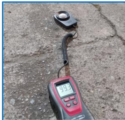
Figura 27. Mediciones Zona 4, Luminarias Encendidas
