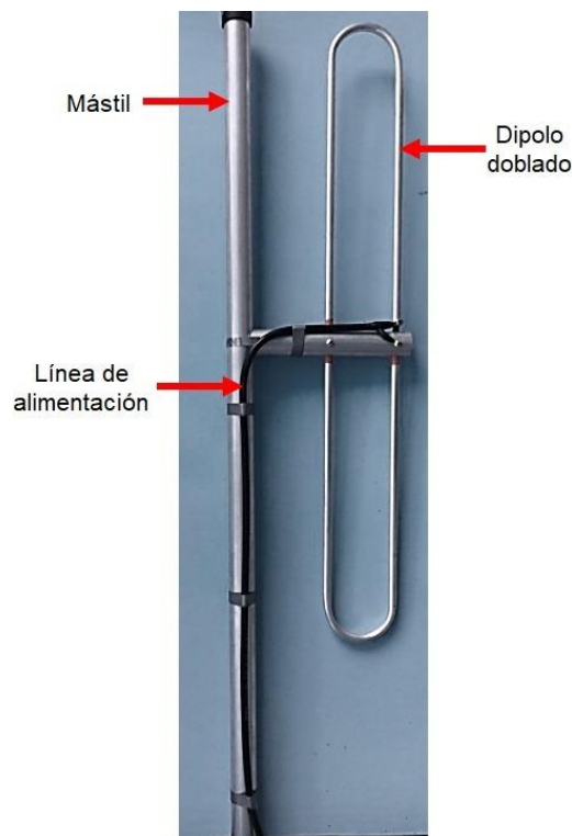
Figura 3.15 Antena dipolo doblado implementada para cobertura local de la estación móvil “EPN”
