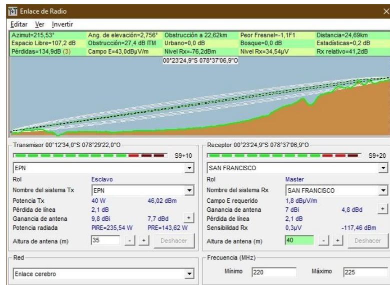
Figura 2.49 Simulación del enlace punto a punto con la antena Landstorfer entre el Nodo “EPN” como transmisor y el Nodo “San Francisco” como receptor en base a los datos de la Tabla 2.5 – Opción 2
