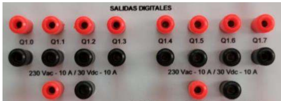
Figura 3.26 Borneras correspondientes a las salidas digitales.
