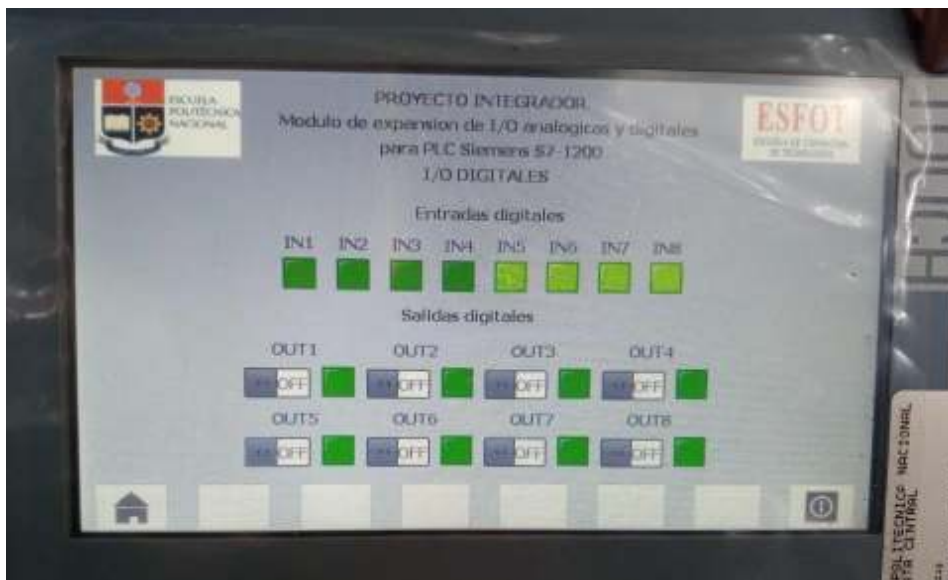
Figura 3.71 Luces indicadoras de entradas digitales en la HMI.
