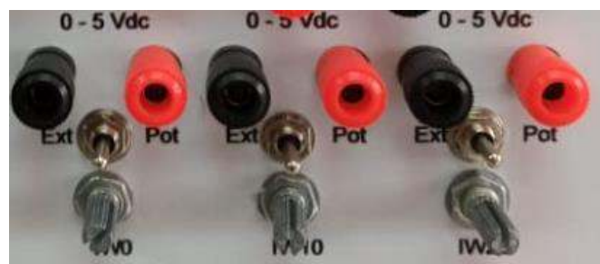
Figura 3.27 Potenciómetros y borneras correspondientes a entradas analógicas.
