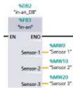
Figura 3.39 Bloque de función para entradas analógicas (in-an).
