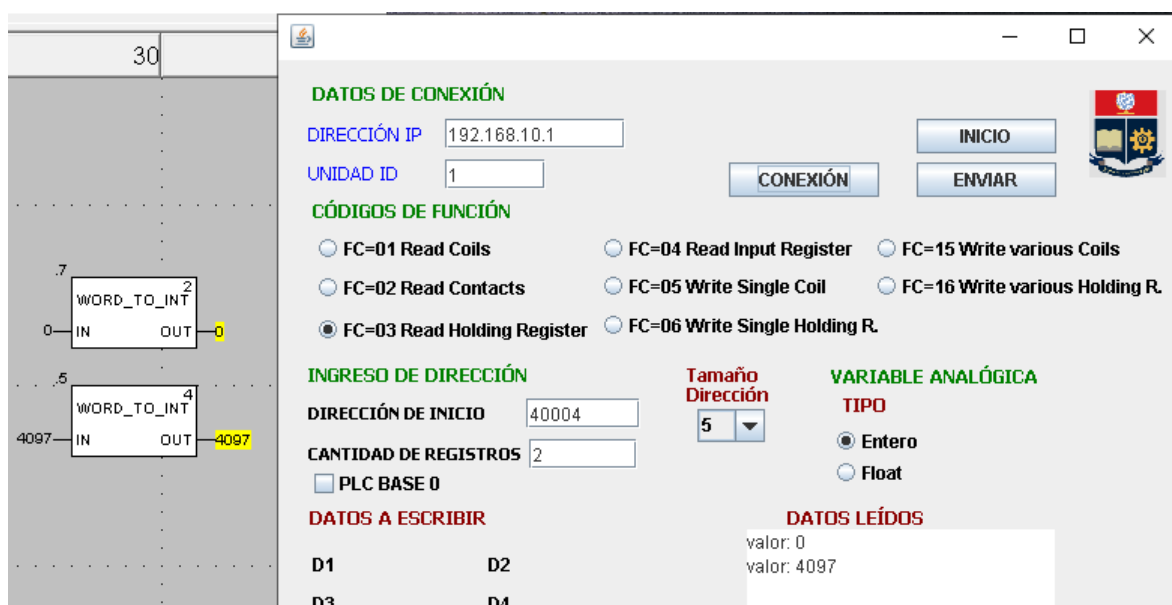
Figura 3.9. Prueba Código de función 03 con PLC M580
