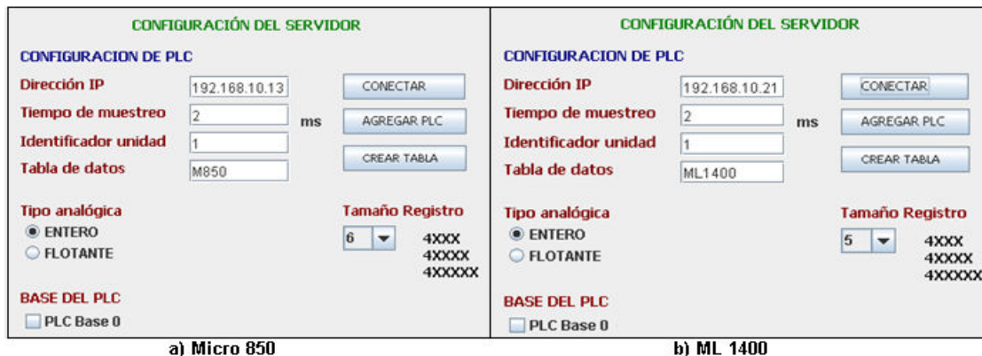
Figura 3.13. Configuración PLC, a) Micro 850 y b) ML1400
