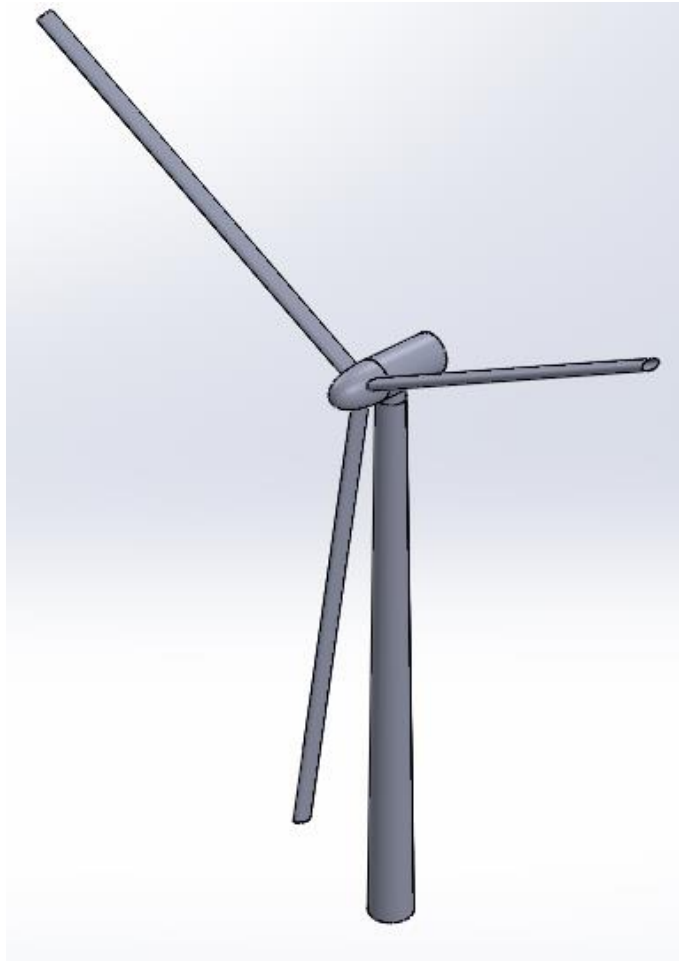
Figura 2. 3. Modelo CAD de la turbina eólica de 10 MW. (Fuente: Propia)
