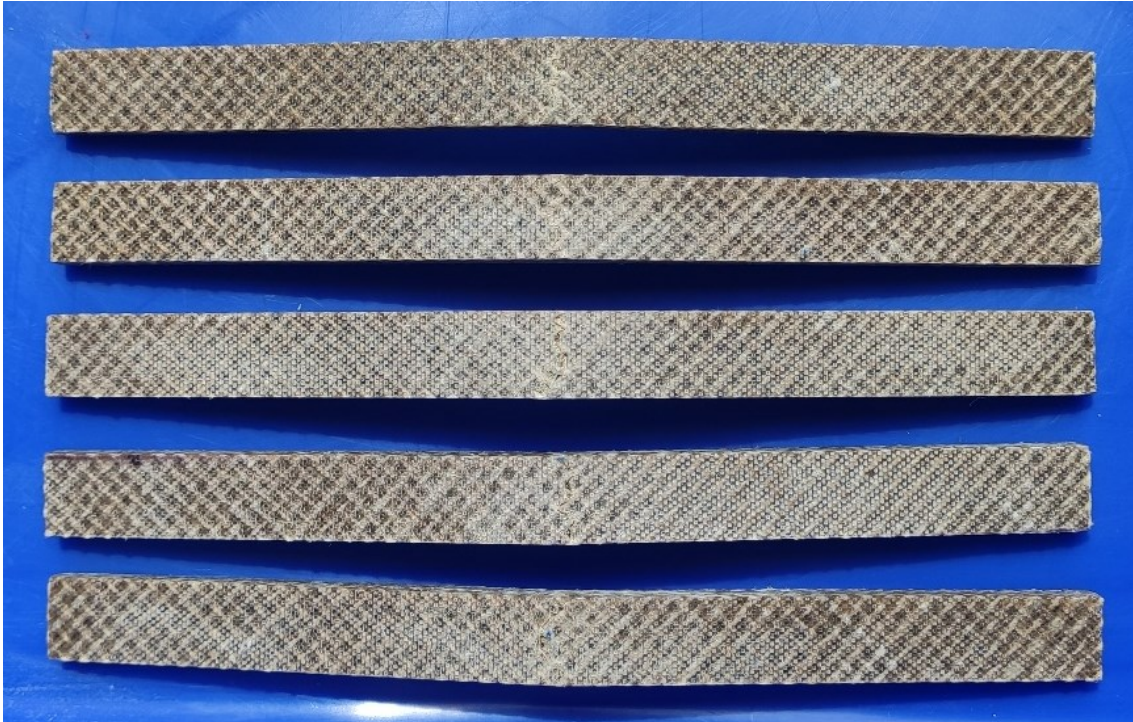
Figura 3.20. Probetas de material compuesto reforzado con tejido después del ensayo de flexión. Vista posterior, desde arriba (FT-1) hasta abajo (FT-5). (Fuente: Propia)
