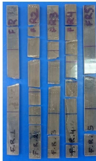
Figura A4. Probetas del grupo "FR" después de los ensayos de flexión.
