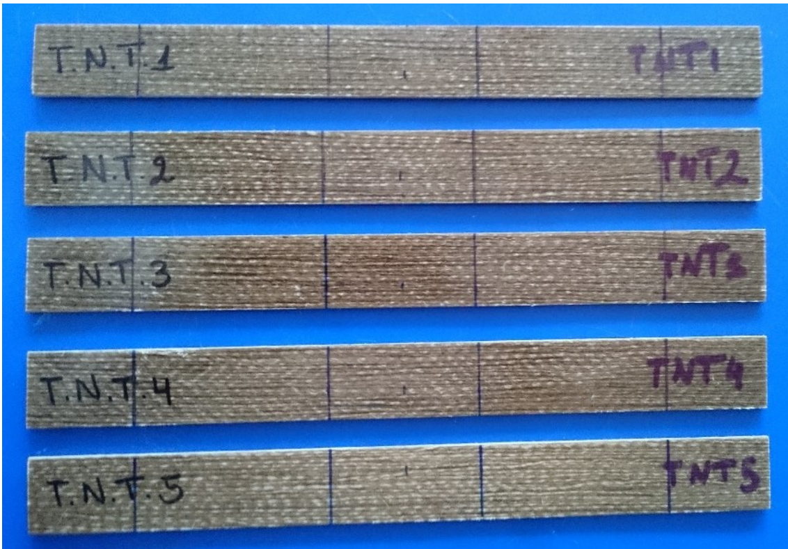
Figura 3.5. Probetas de material compuesto reforzado con no tejido previo al ensayo de tracción. (Fuente: Propia)
