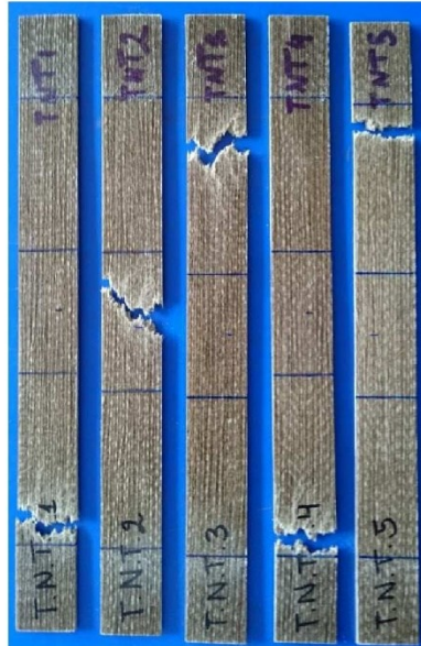
Figura A3. Probetas del grupo "TNT" después de los ensayos de tracción.
