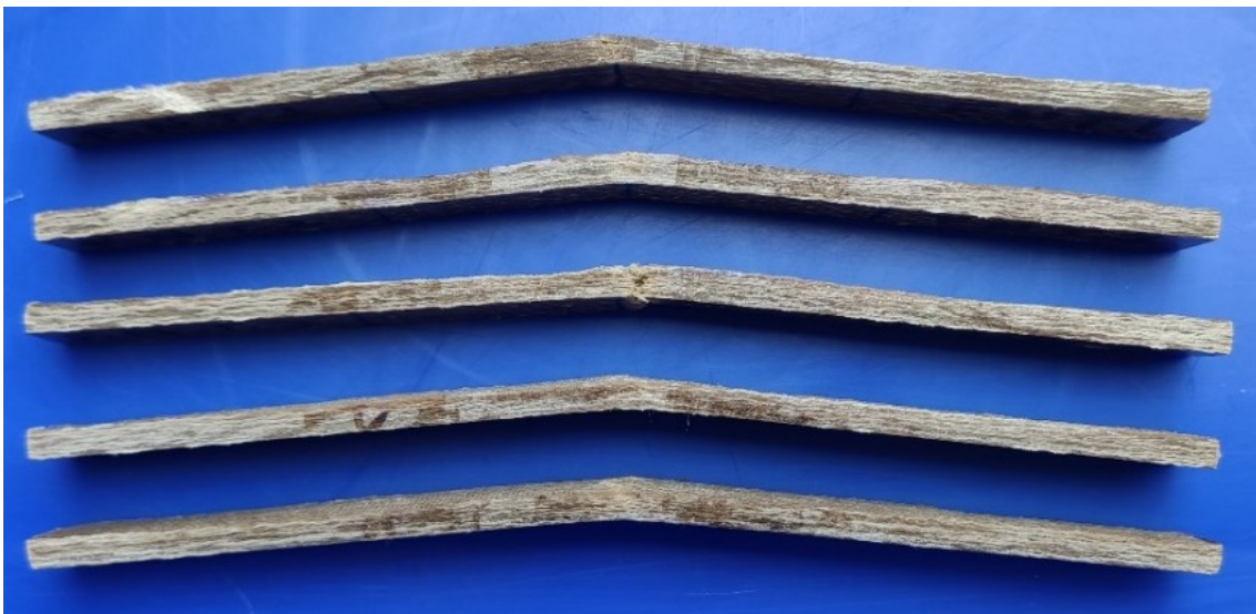
Figura 3.17. Probetas de material compuesto reforzado con no tejido después del ensayo de flexión. Vista lateral, desde arriba (FNT-1) hasta abajo (FNT-5). (Fuente: Propia)
