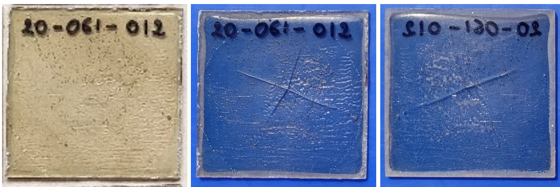
Figura 3.23. Probeta de resina previo al ensayo de impacto. Probeta ensayada vista frontal y vista posterior. (Fuente: Propia)
