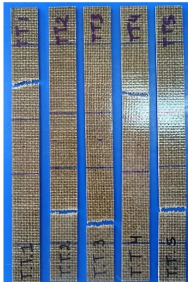
Figura A2. Probetas del grupo "TT" después de los ensayos de tracción.
