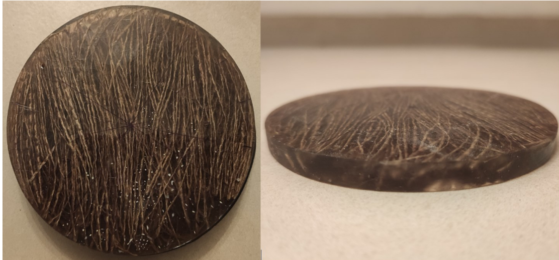
Figura 2.37. Probeta cilíndrica de material compuesto con refuerzo no tejido. (Fuente: Propia)
