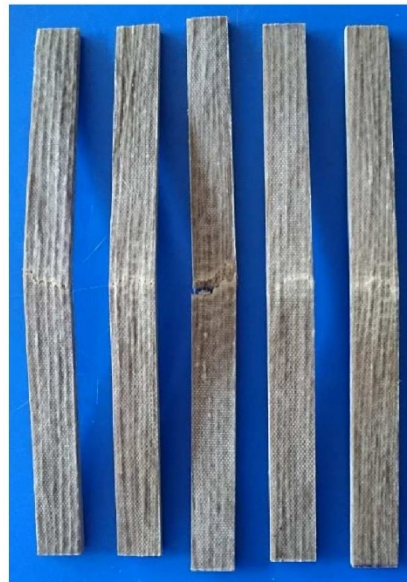
Figura A6. Probetas del grupo "FNT" después de los ensayos de flexión.
