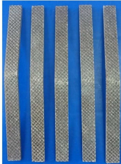
Figura A5. Probetas del grupo "FT" después de los ensayos de flexión.
