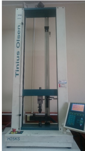
Figura 2.19. Máquina universal de ensayos Tinius Olsen H25KS. (Fuente: Propia)
