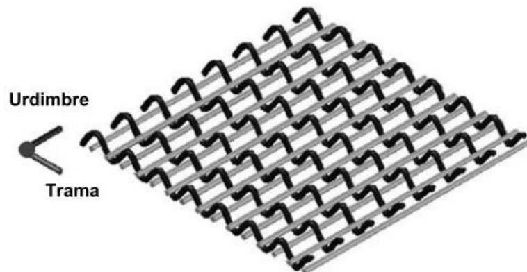
Figura 1.3. Diseño esquemático de un tejido. (Fuente: [2])
