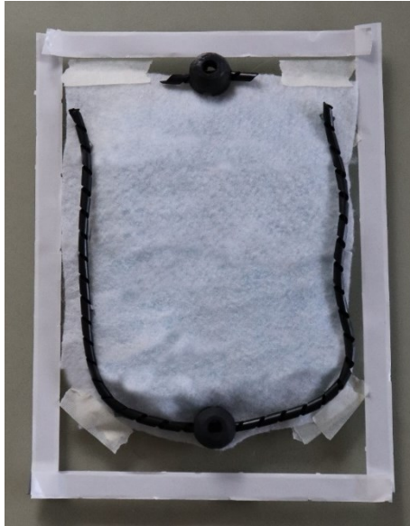
Figura 2.26. Líneas de conducto y conectores. (Fuente: Propia)
