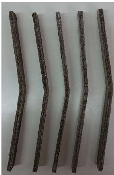
Figura A2. Probetas del grupo "FT" después de los ensayos de flexión.
