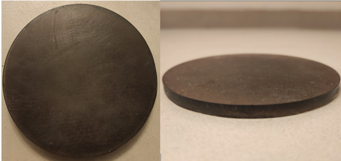
Figura 2.35. Probeta cilíndrica de resina. (Fuente: Propia)
