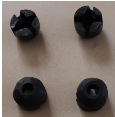
Figura 2.8. Conectores para infusión de resina. (Fuente: Propia)
