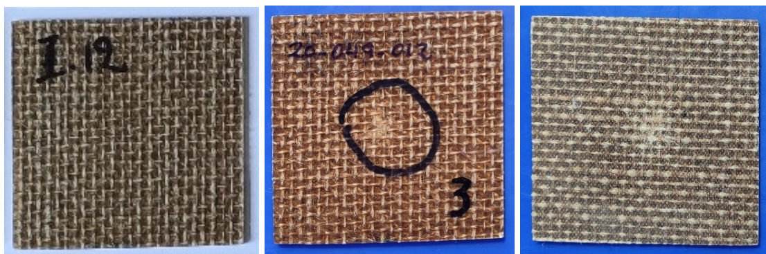
Figura 3.24. Probeta de material compuesto reforzado con tejido previo al ensayo de impacto. Probeta ensayada vista frontal y vista posterior. (Fuente: Propia)
