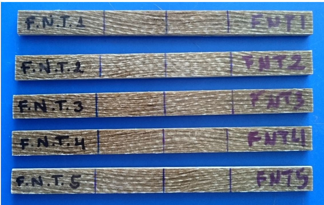
Figura 3.15. Probetas de material compuesto reforzado con no tejido previo al ensayo de flexión. (Fuente: Propia)
