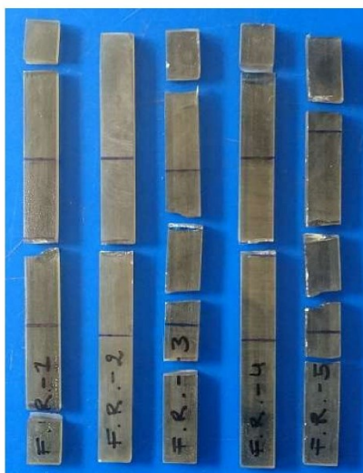
Figura A1. Probetas del grupo "FR" después de los ensayos de flexión.
