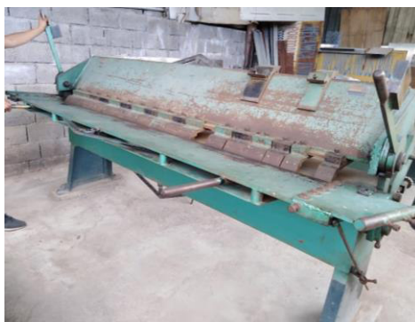
Figura 3.8 Dobladora manual para tol metálico.
