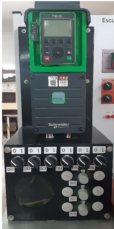
Figura 3.10 Soporte prefabricado y Variador ATV-630.
