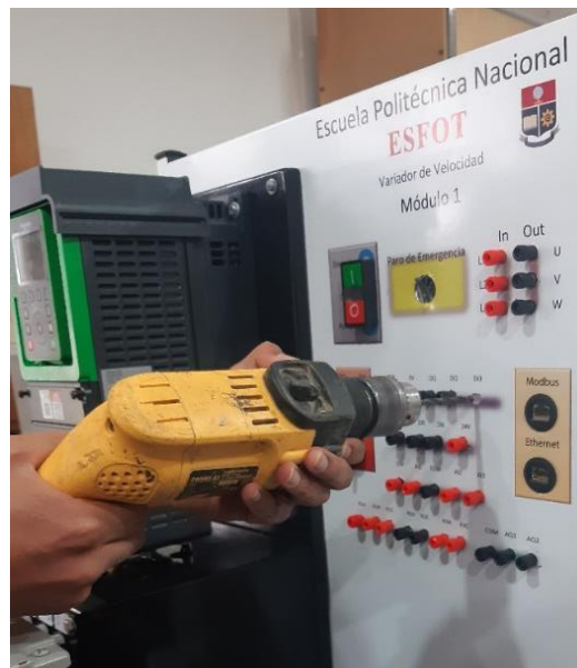
Figura 3.15. Perforaciones realizadas en el panel de conexiones
