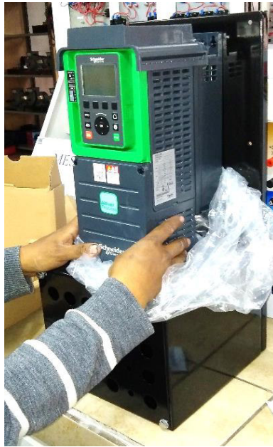
Figura 3.13 Colocación del Variador de frecuencia en el soporte prefabricado.
