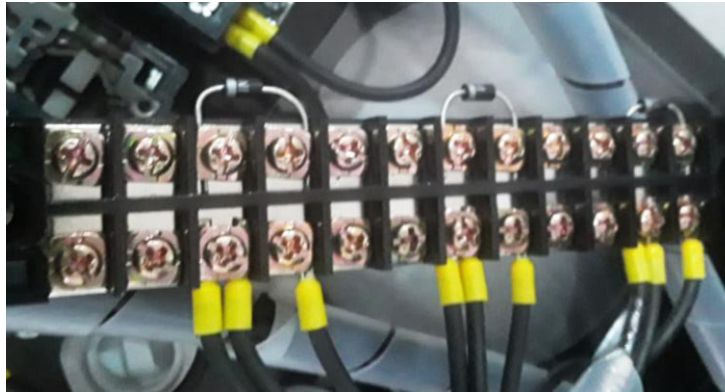
Figura 3.24 Conexión entre los potenciómetros y los diodos 1N4007.
