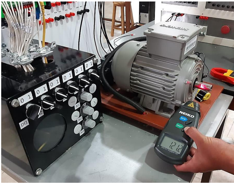
Figura 3.26 Pruebas de velocidad usando tacómetro digital.
