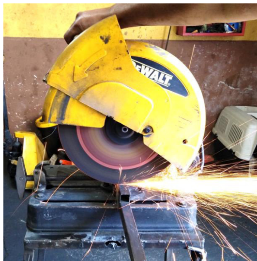
Figura 3.6 Corte de Material para módulos.
