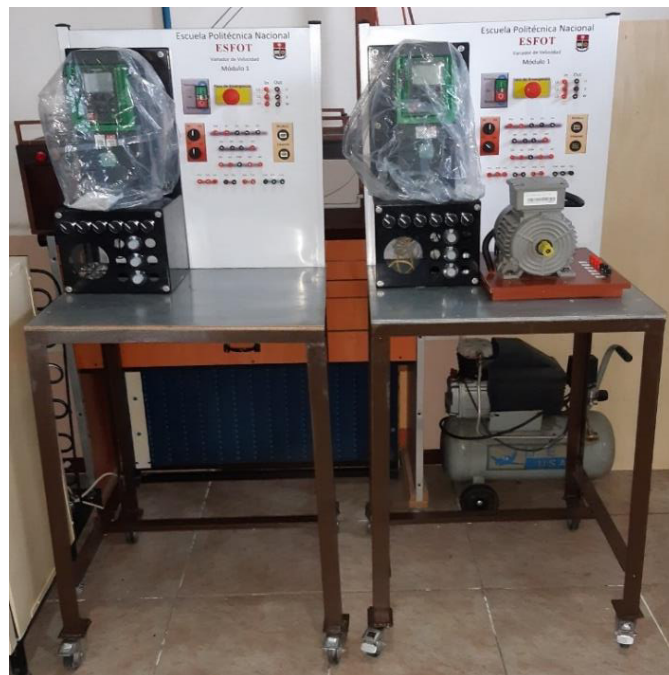
Figura 3.20 Módulos para variadores de velocidad implementados.
