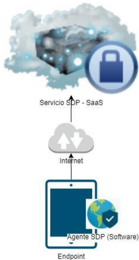
Figura 3.8 Arquitectura de la solución implementada
