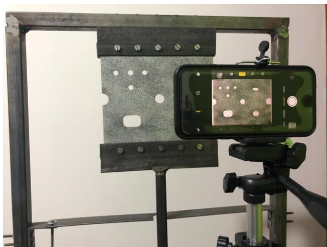
Figura 9.1 Adquisición de las fotografías de una probeta de nitrilo sometida a tracción.
