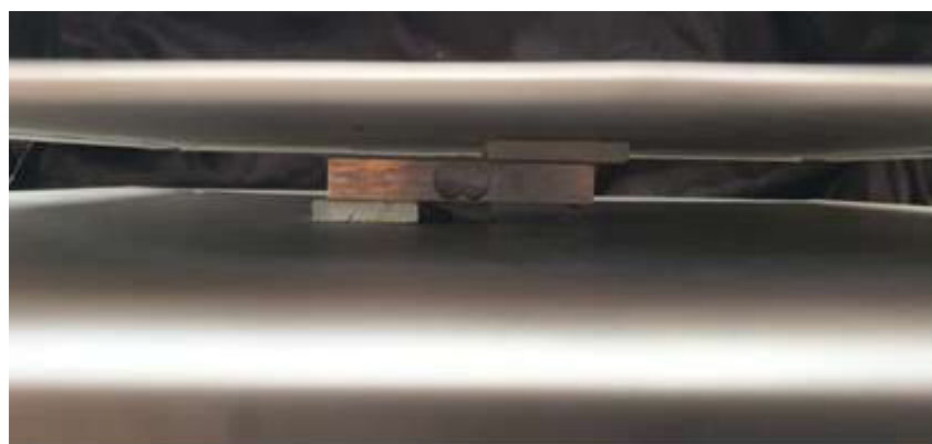
Figura 2.14. Vista lateral de la celda de carga sujetando a la base y a la bandeja a través de dos soportes que evitan el contacto de sus superficies.
