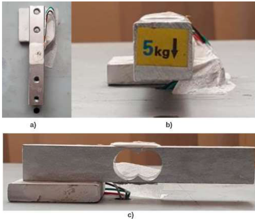
Figura 2.13. Celda de carga sujeta a la base de la balanza, vista desde diferentes puntos antes de colocar la bandeja. a) Vista superior b) Vista frontal c) Vista lateral.
