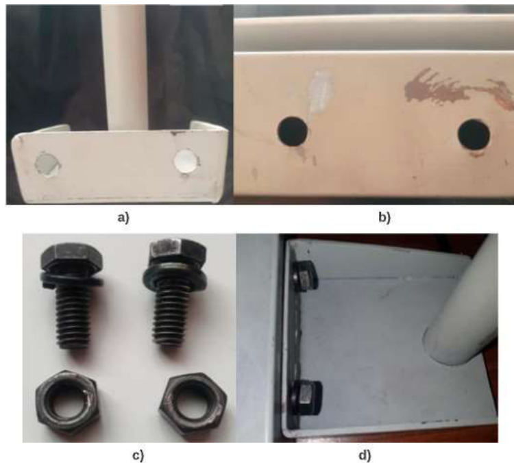
Figura 2.8. a) Orificios de la base del soporte del sistema de adquisición de imágenes. b) Orificios de la base de la balanza digital. c) Tuercas para unir el soporte del sistema de adquisición de imágenes con la balanza digital. d) Unión terminada entre el soporte del sistema de adquisición de imágenes con la balanza digital.
