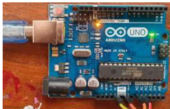
Figura 2.16. Arduino UNO utilizado para recoger la señal del transmisor HX711 y enviarlo a la PC
