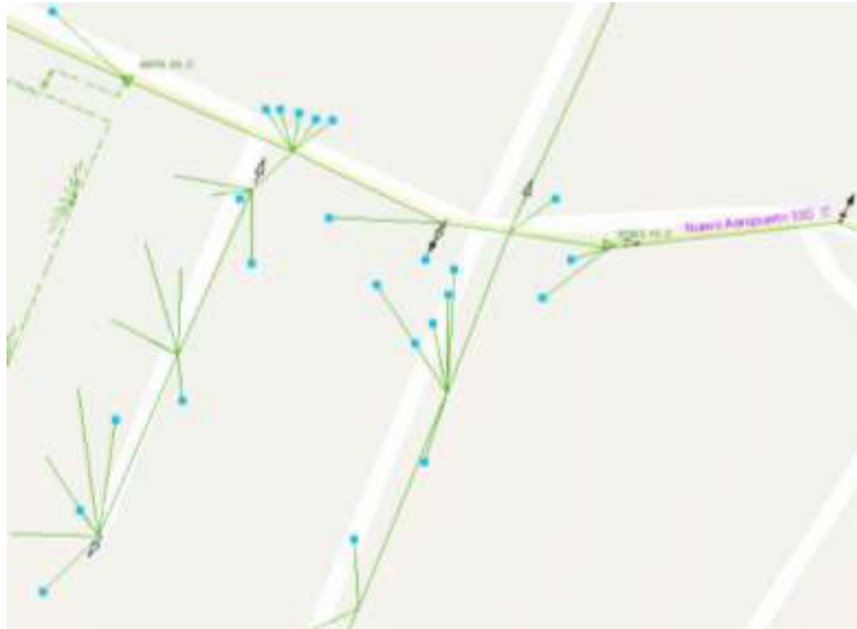
Figura 3.6 Distribución radial con disposición monofásica [11].
