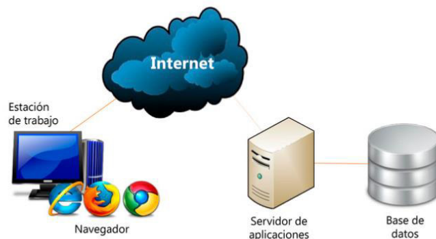
Figura 1.1 Esquema del prototipo de aplicación web para la gestión de torneos deportivos.
