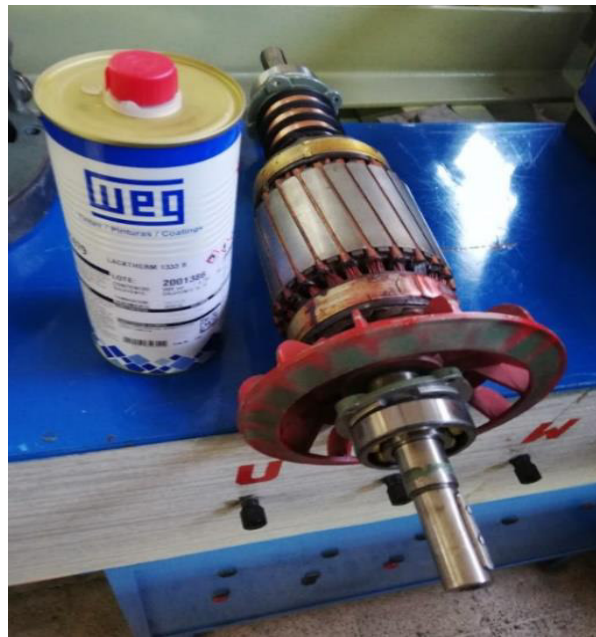
Figura 4.9. Barniz dieléctrico y rotor máquina de inducción libre de suciedades.
