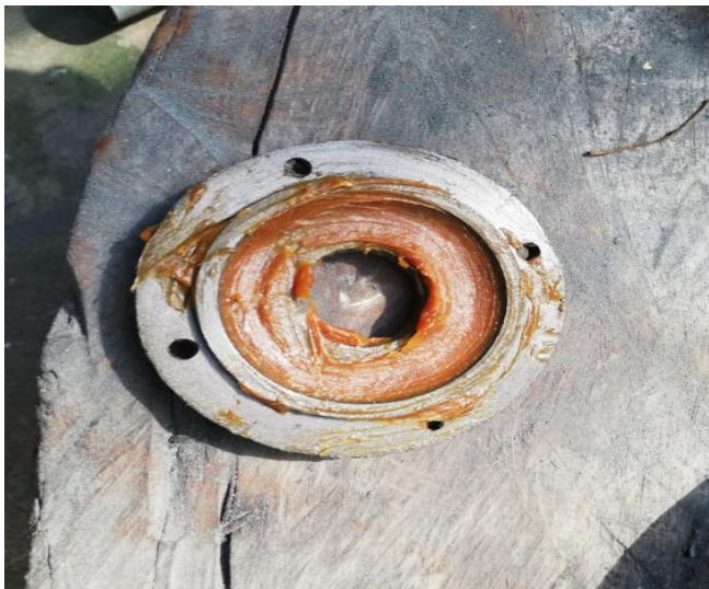
Figura 4.7. Tapa de rodamientos con grasa en total deterioro.
