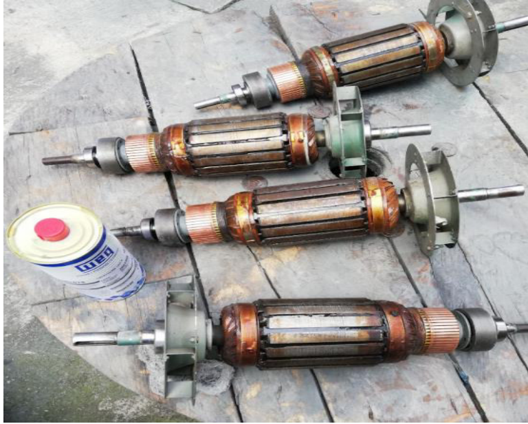
Figura 4.10. Barnizado de rotores correspondientes a máquinas de corriente continua.
