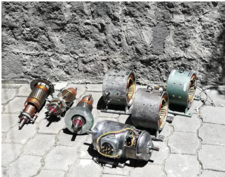
Figura 4.11. Secado de las máquinas eléctricas.
