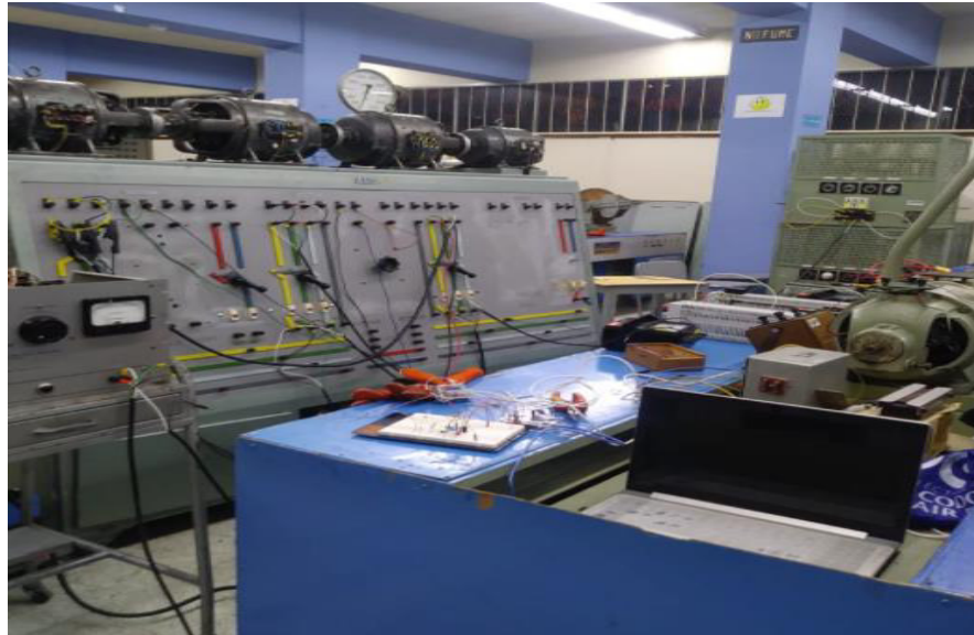
Figura 4.70. Circuito de Rechazo de carga máquina híbrida (generador 3).
