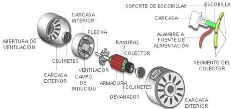
Figura 2.26. Partes de una máquina de corriente continua.
