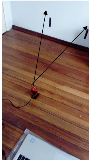
Figura 2.15 Marcas que coinciden con campo de visión de la cámara
