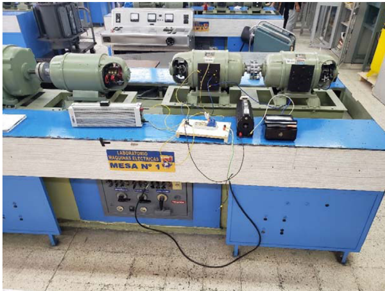
Figura 3.5 Prueba de circuito abierto de la máquina de corriente continua
