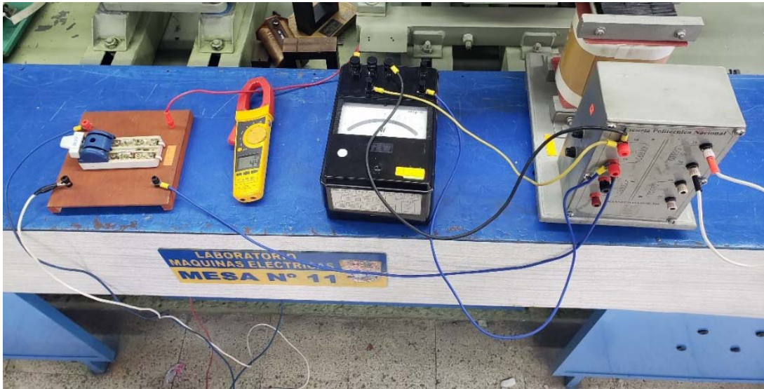
Figura 3.2 Prueba de corto circuito del transformador monofásico
