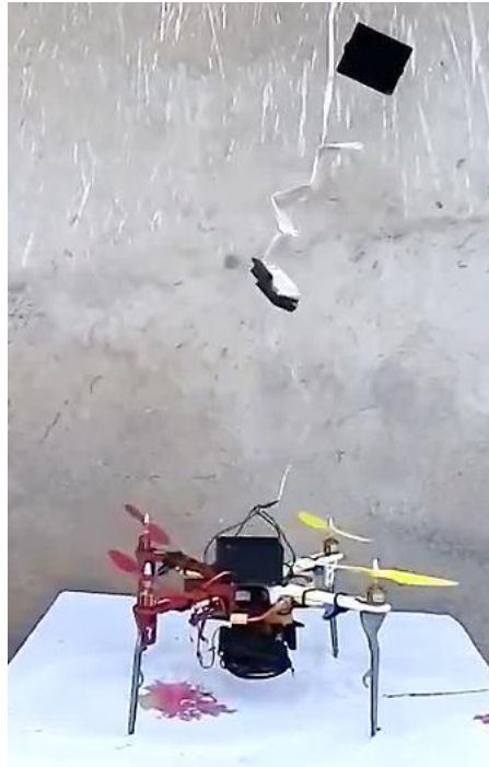
Figura 3.50 Expulsión de forma manual el paracaídas (Fuente propia)
