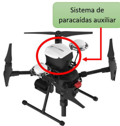
Figura 3.2 Sistema SafeAir para un UAV modelo DJI M200 [17]
