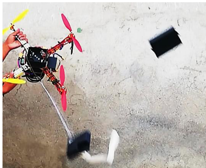
Figura 3.51 Expulsión de forma automática del paracaídas (Fuente propia)
