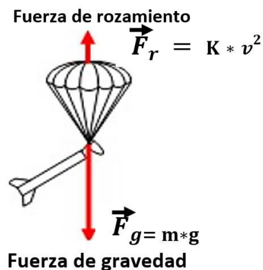
Figura 3.28 Descenso de un modelo aéreo utilizando un paracaídas [44]
