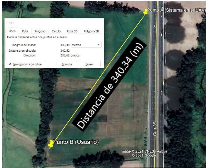
Figura 3.55 Distancia recorrida para la prueba de comunicación con línea de vista (Fuente propia)
