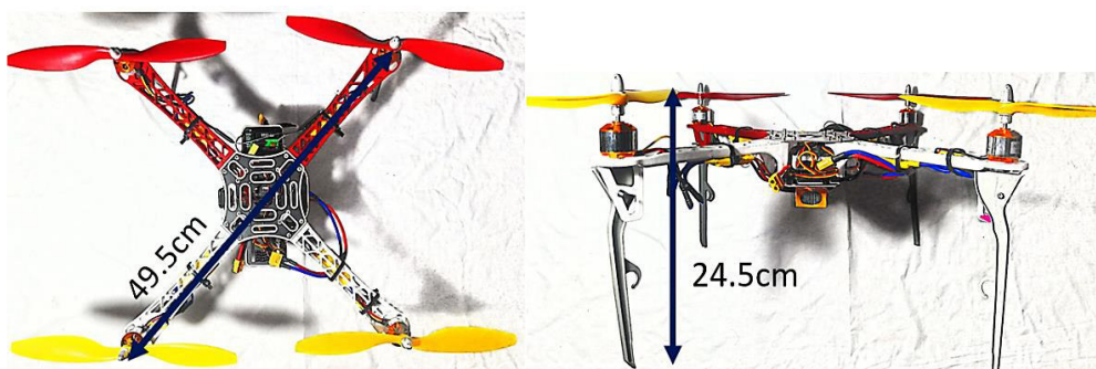
Figura 3.29 Dimensiones del cuadricóptero (Fuente propia)
