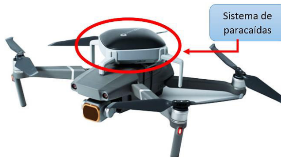
Figura 3.3 Dron DJI Mavic 2 con el sistema de emergencia denominado SafeAir [18]
