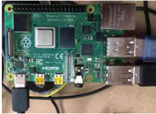
Figura 3.12 Raspberry Pi 4 modelo B.
