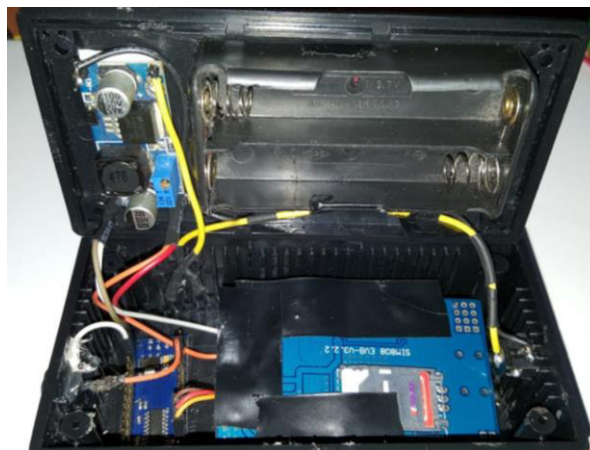
Figura 3.97 Ensamble de geo-posicionamiento a 2 baterías
