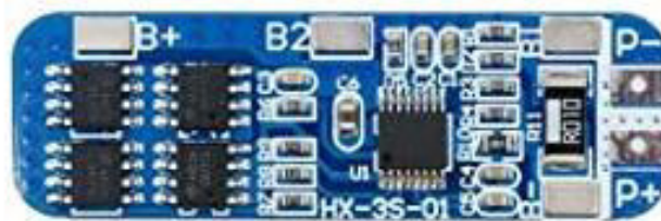
Figura 3.10 Cargador de 3 baterías 18650 Módulo BMS 3S 10 (A)
