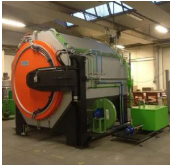
Figura 1.17 Horno de vacío.
