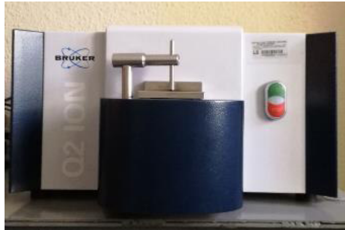
Figura 2.2 Equipo de espectrometría Bruker Q2 ION. (Fuente: Propia)
