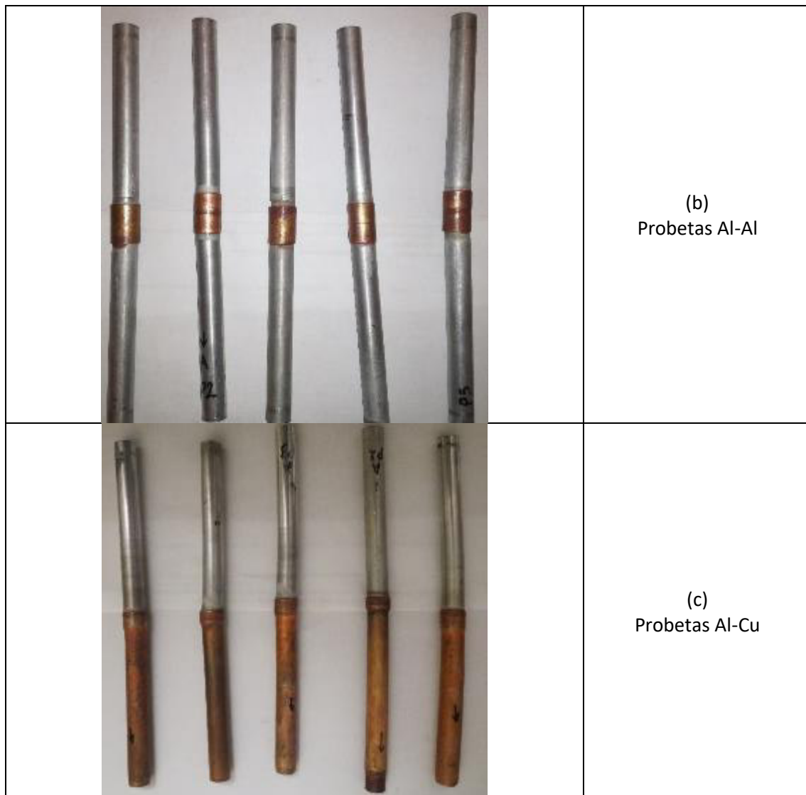
Figura 2.14 Probetas soldada con el proceso experimental. (Fuente: Propia)
