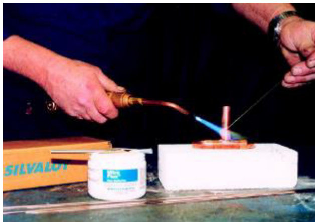
Figura 1.11 Soldadura fuerte por antorcha de una tubería de cobre. (Fuente: AMERICAN WELDING SOCIETY, Brazing Handbook, 5ª Edition, p.p. 238)
