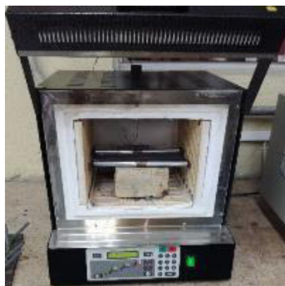
Figura 2.13 Probetas de aluminio introducidas en el horno mufla. (Fuente: Propia)
