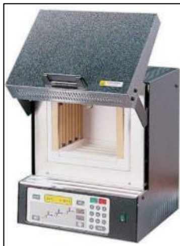
Figura 2.17 Horno Mufla usado para efectuar el proceso de soldadura. (Fuente: https://www.amazon.com/-/es/neytech-9493308-Vulcan-550-CU-3-Stage-programable/dp/B00NG2KK4A )
