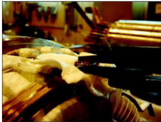
Figura 1.20 Soldadura fuerte por resistencia de un elemento de un estator. (Fuente: AMERICAN WELDING SOCIETY, Brazing Handbook, 5 o Edition, p.p. 338)
