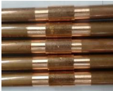
Figura 2.11 Probetas de cobre con las superficies listas para soldar. (Fuente: Propia)
