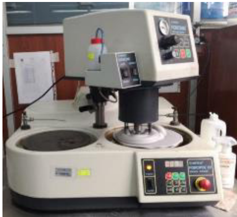
Figura 2.8 Pulido de probetas. (Fuente: propia)
