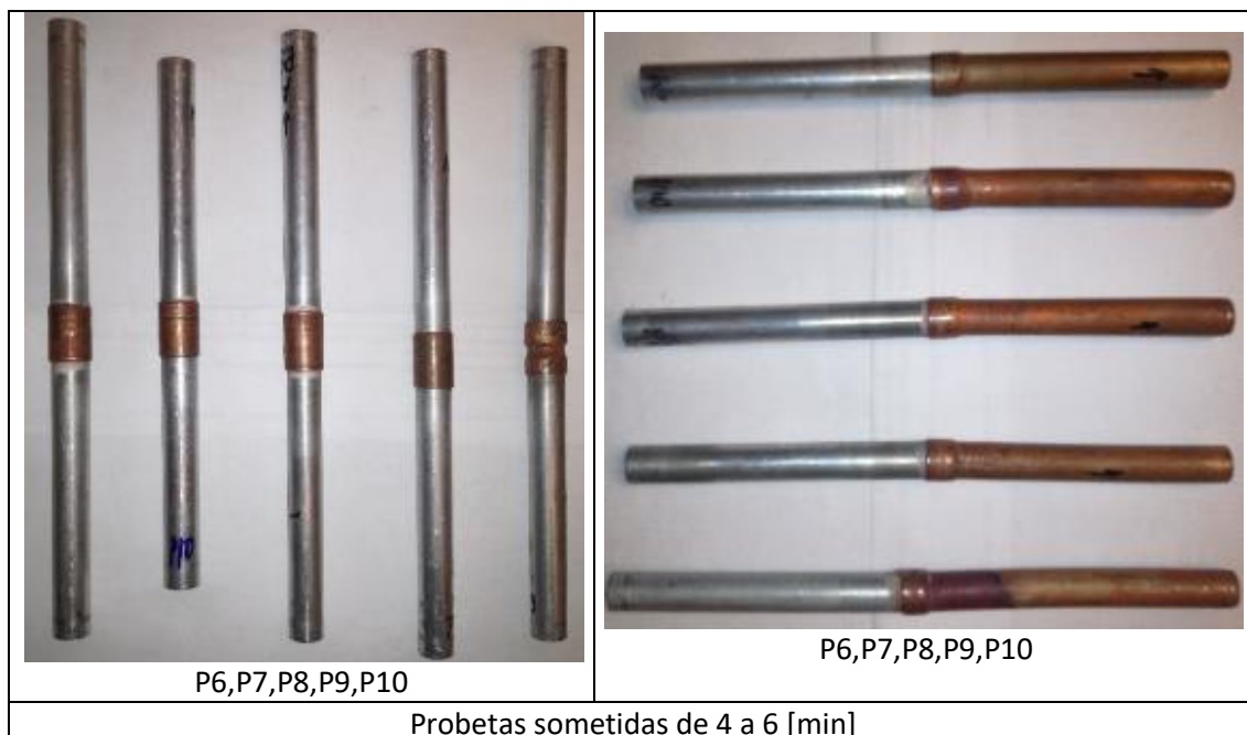
Figura 2.16 Probetas soldadas en un tiempo de 4 a 6 [min]. (Fuente: Propia)
