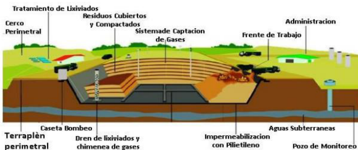
Figura 14. Componentes de un relleno sanitario
