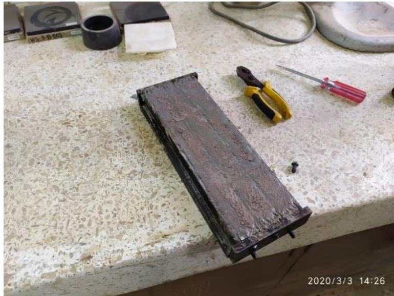
Figura 4.8 Barras de mortero por desencofrar
