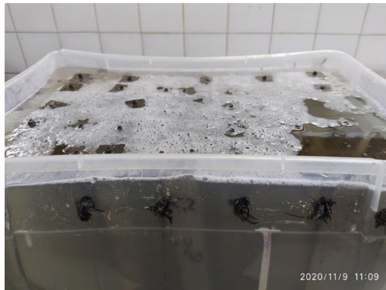
Figura 4.12 Inmersión de las barras en la solución de NaOH
