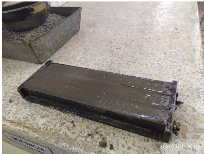
Figura 4.7 Moldeo y alisado de barras de mortero
