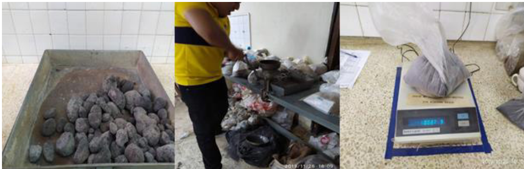
Figura 3.18 Proceso de trituración de puzolana volcánica para ensayo.
