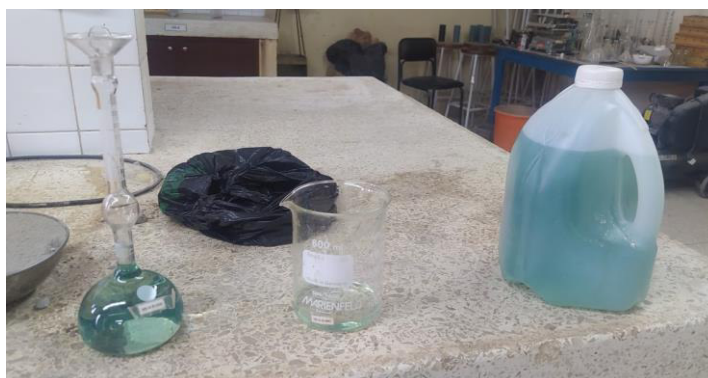
Figura 3.13 Ensayo de densidad real del cemento.
