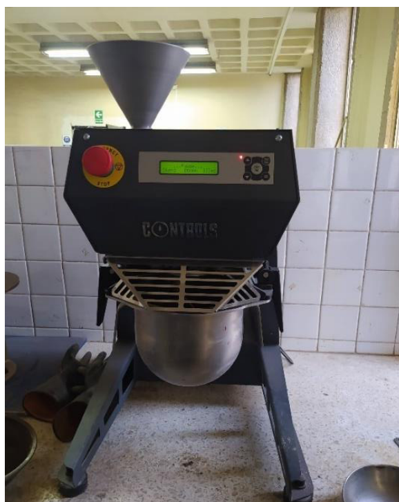
Figura 4.4 Mezcladora electrónica facilitada por el LEMSUR que se usó para la mezcla del mortero
