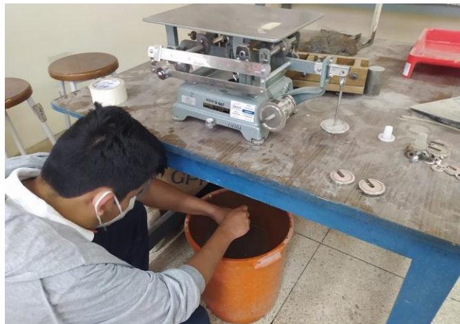
Figura 3.11 Ensayos de peso específico y absorción de agregados.
