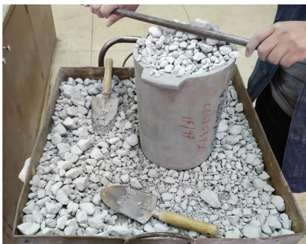
Figura 3.12 Ensayo de densidad aparente del agregado.
