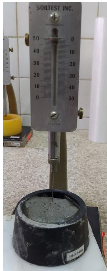
Figura 3.16 Ensayo de tiempos de fraguado del cemento.
