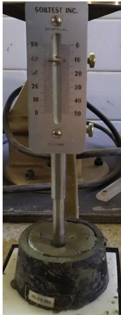
Figura 3.14 Ensayo de consistencia normal del cemento.
