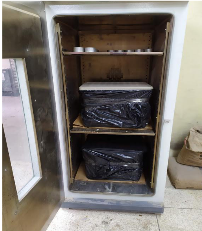
Figura 4.10 Barras sumergidas en agua en un horno a 80°C
