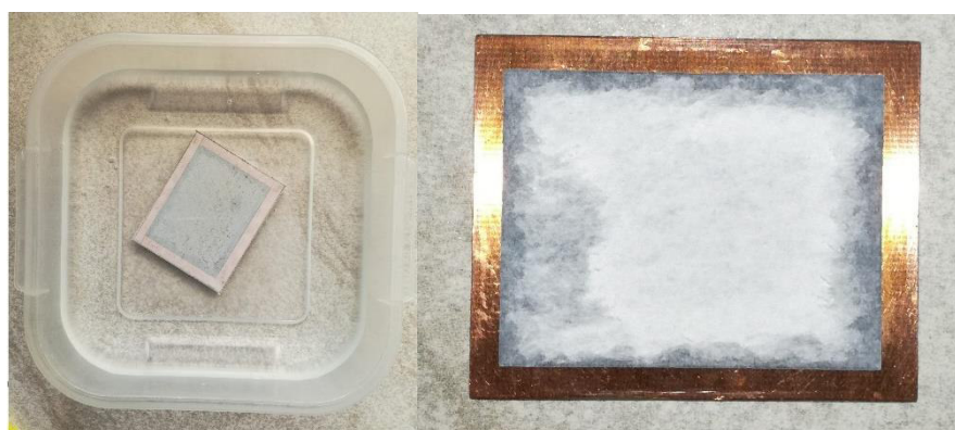
Figura 3.57. Antena tipo parche rectangular con tinta transferida.
