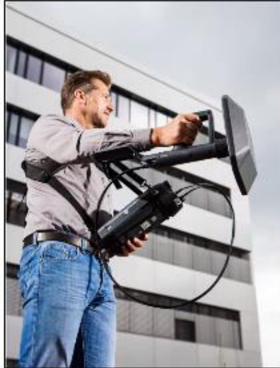
Figura 1.22. Determinación manual del ángulo de arribo [23].
