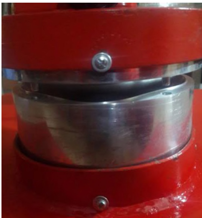
Figura 2. 112. Alineamiento de los moldes y montaje de los moldes con la estructura. (Fuente: Propia)
