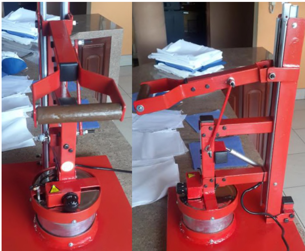
Figura 2. 111. Máquina termoformadora ensamblada (Moldes unidos). (Fuente: Propia)
