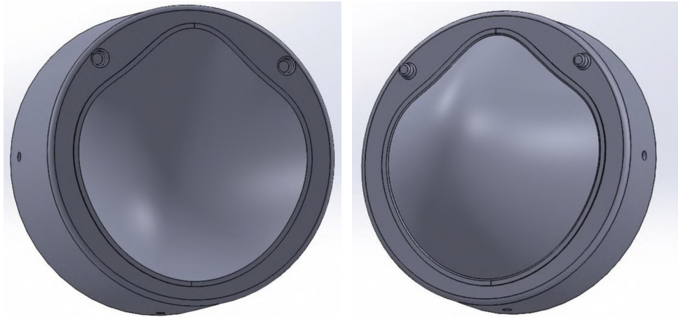
Figura 2. 72. Moldes positivo y negativo con la configuración final. (Fuente: Propia)
