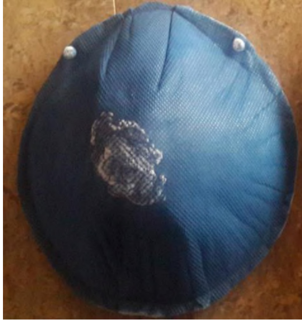
Figura 2. 122. Mascarilla termoformada por tiempo prolongado. (Fuente: Propia)
