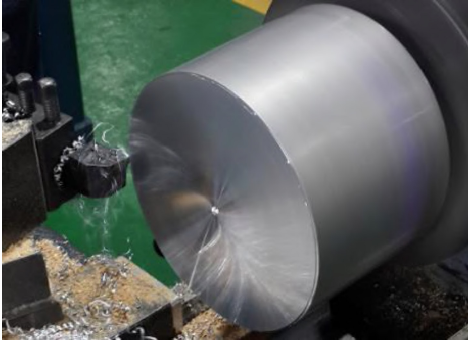
Figura 2. 102. Refrentado del molde positivo. (Fuente: Propia)
