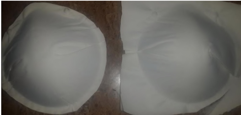
Figura 2. 120. Mascarillas con capa externa de poliéster antifluido. (Fuente: Propia)
