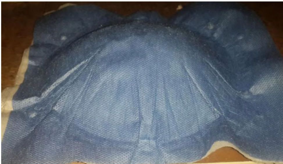
Figura 2. 123. Mascarilla expuesta a una temperatura menor a 150°C. (Fuente: Propia)
