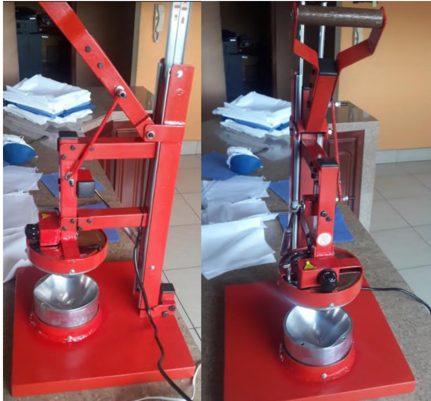
Figura 2. 110. Máquina termoformadora ensamblada (Moldes separados). (Fuente: Propia)
