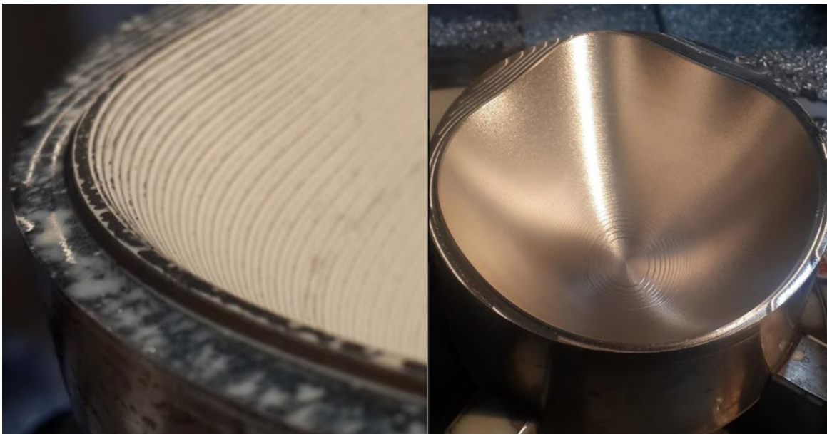
Figura 2. 109. Acabado con fresa plana de 3 mm y redonda de 6 mm. (Fuente: Propia)
