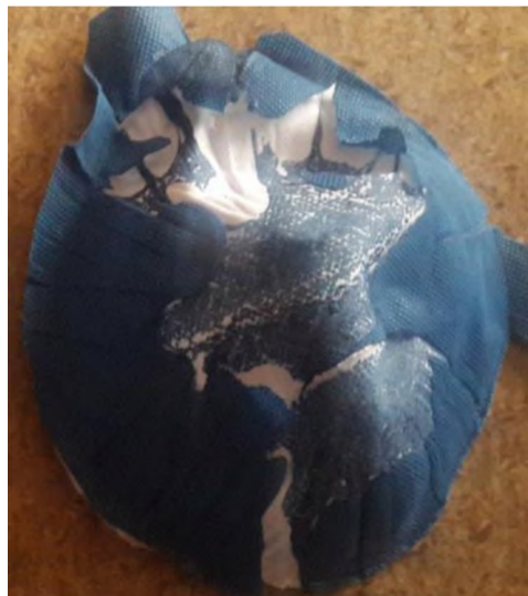
Figura 2. 121. Mascarilla expuesta a una temperatura mayor a 150°C. (Fuente: Propia)
