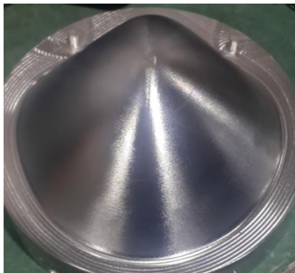
Figura 2. 107. Acabado final del molde positivo. (Fuente: Propia)
