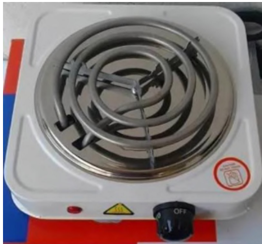
Figura 2. 64. Cocineta eléctrica usada como sistema de calentamiento. (Fuente: Propia)
