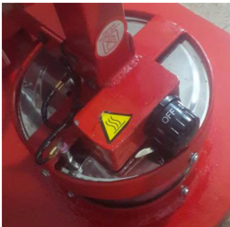
Figura 2. 113. Sistema de calentamiento colocado dentro del molde positivo. (Fuente: Propia)
