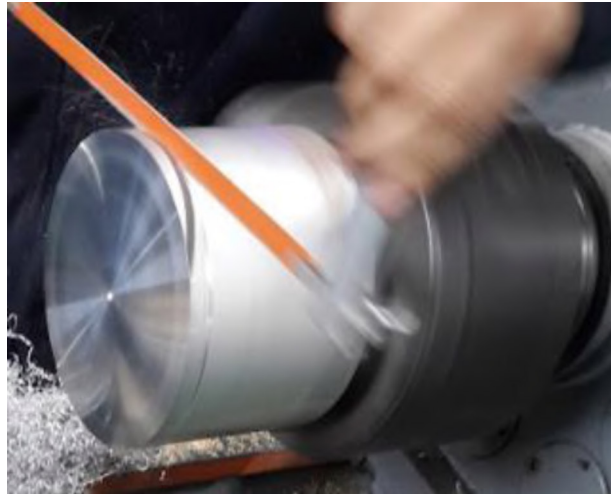
Figura 2. 104. Corte con sierra del molde positivo. (Fuente: Propia)
