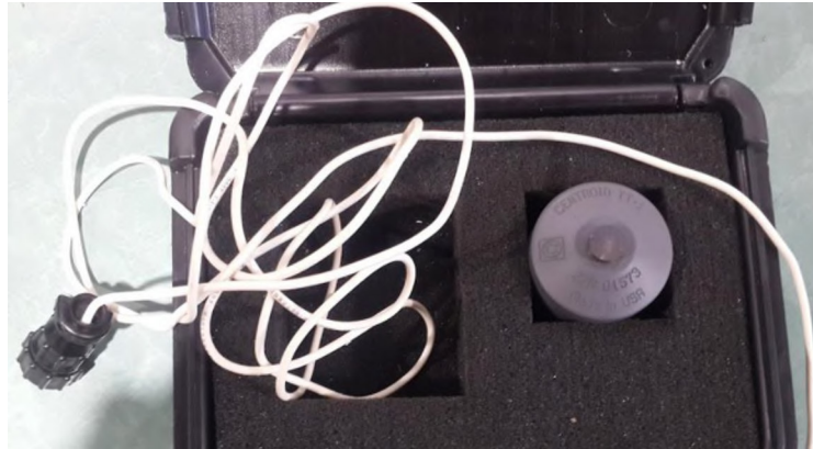
Figura 2. 93. Palpador “CENTROID TT-1 S/N 01573”. (Fuente: Propia)
