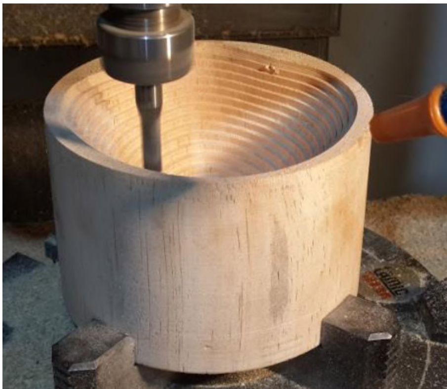
Figura 2. 98. Trabajo en madera con una fresa de 19 mm. (Fuente: Propia)
