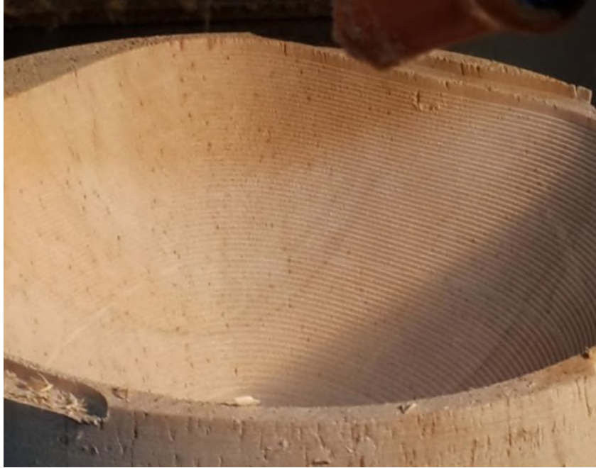
Figura 2. 99. Trabajo en madera con una fresa de 8 mm. (Fuente: Propia)
