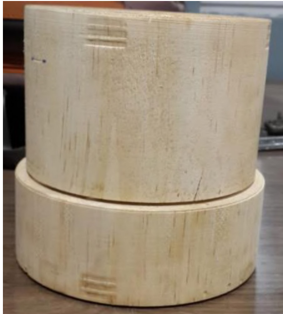
Figura 2. 101. Molde positivo y negativo de madera encajados. (Fuente: Propia)
