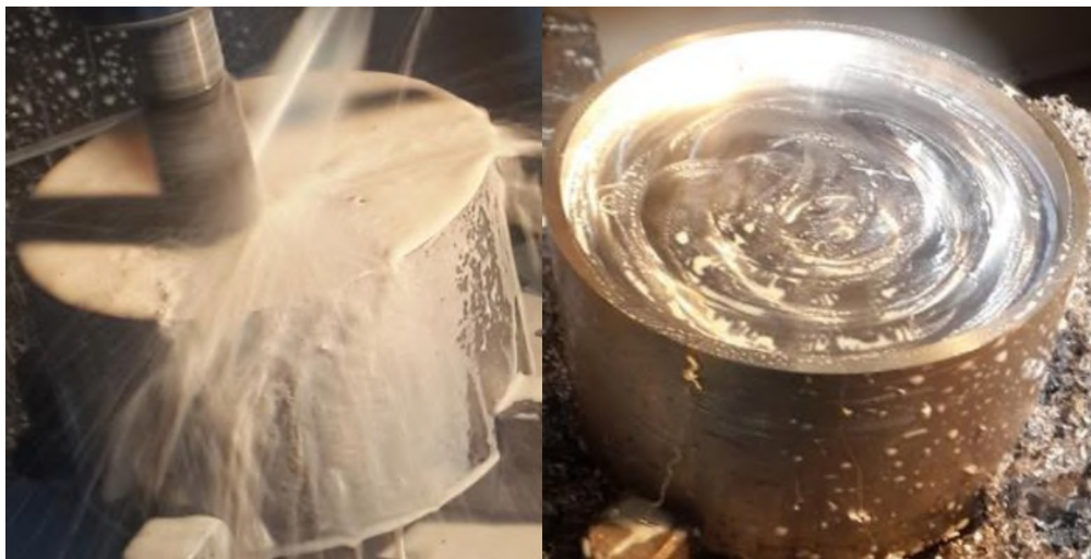
Figura 2. 105. Antes y después de usar la fresa de 30 mm. (Fuente: Propia)
