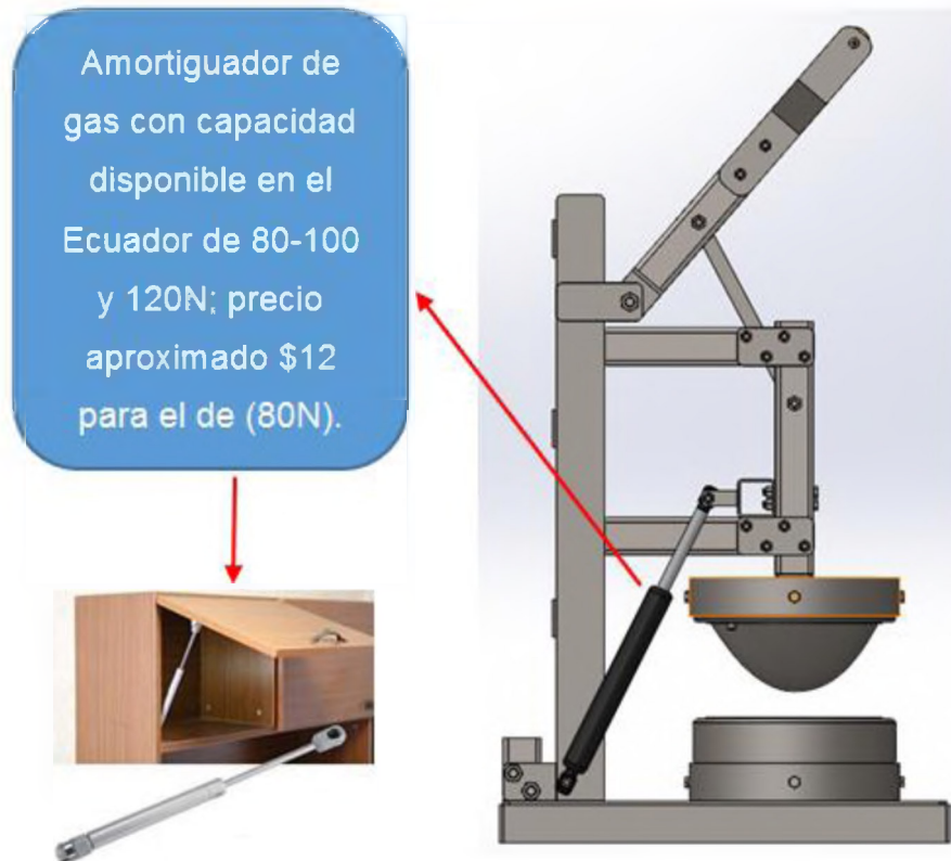
Figura 2. 29. Dispositivo para posicionamiento inicial de la termoformadora. (Fuente: Propia)
