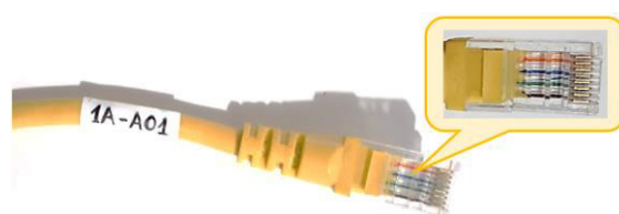
Figura 1.9 Etiquetado y ponchado del cable UTP
