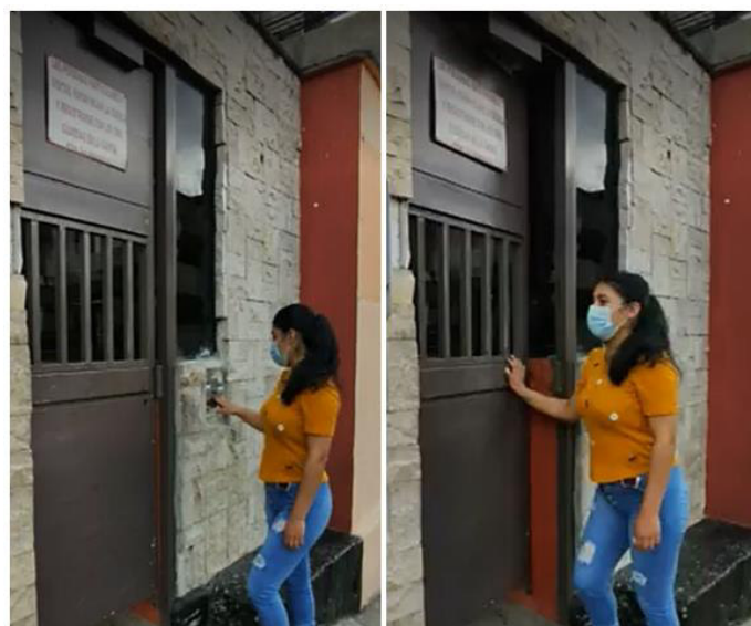
Figura 3.34 Comprobación de huella dactilar con el biométrico MA300
