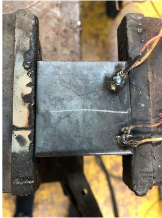
Fig. 2.3 Fijación de termopares en clavos
