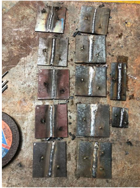
Fig. 2.2 Puntos de medición en placas soldadas
