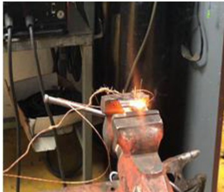
Fig. 2.4 Fijación de termopares en clavos en placa soldada
