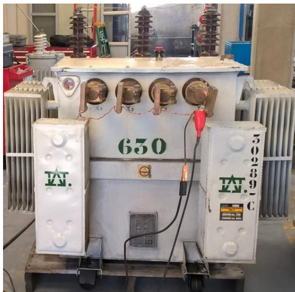
Figura 1.11. Tanque de un transformador con radiadores. (Elaboración propia).
