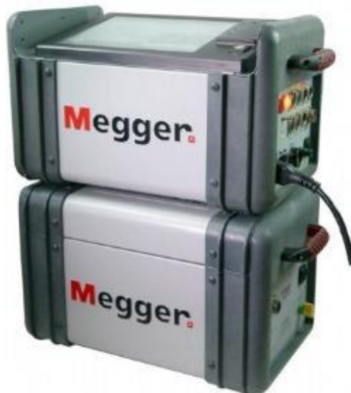
Figura 2.10. Equipo DELTA 4000 de Megger para pruebas de FP/FD [19].
