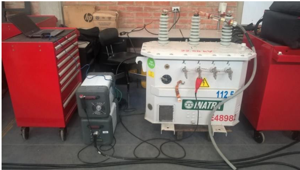
Figura 2.17. Pruebas de FP/FD en el Laboratorio de transformadores de la EEQSA. (Elaboración propia).
