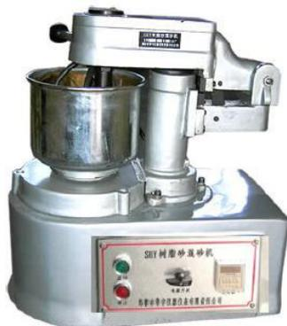
Figura 2.2. Mezcladora de arena y resina SHY del Laboratorio de Metales y Arenas de la Empresa FUNDIRECICLAR S.A.
