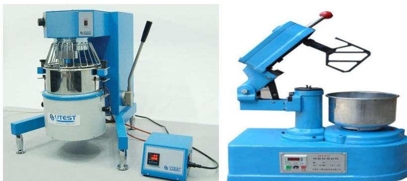
Figura 1.20. Mezcladora de laboratorio UTG-130 de 10 litros de capacidad y mezcladora de arena y resina SHY,
