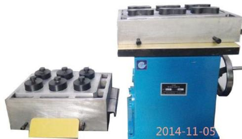
Figura 2.3. Máquina para fabricar probetas de mezclas de moldeo.
