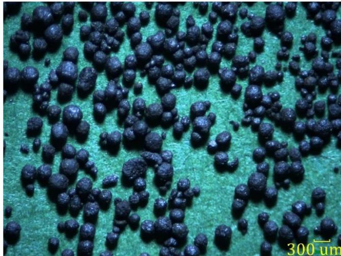
Figura 3.4. Corindón Cast Ball, aumento de 20X.
