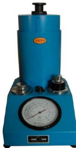
Figura 2.7. Medidor de Permeabilidad.
