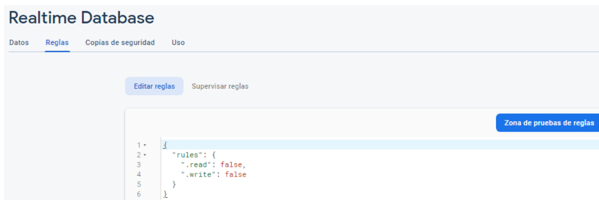
Figura 2.48 Reglas de seguridad deshabilitadas por defecto
