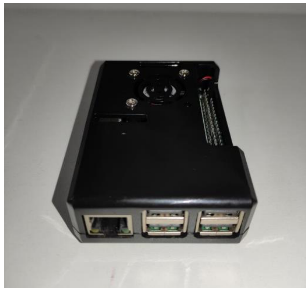
Figura 3.1 Raspberry Pi en su caja de protección y ventilación (1)
