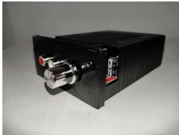
Figura 3.4 Módulo amplificador en su caja de protección (2)
