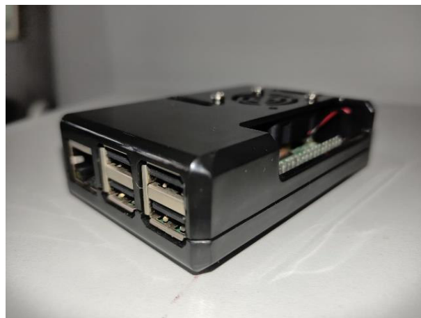
Figura 3.2 Raspberry Pi en su caja de protección y ventilación (2)
