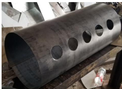
Figura 3.9 Tanque interno de Acero A36
