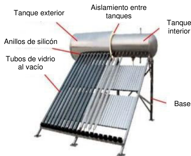
Figura 1.1 Componentes de un calentador solar [5]
