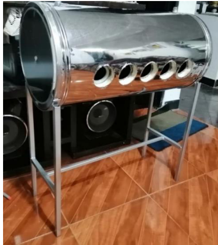
Figura 3.11 Termotanque y soporte
