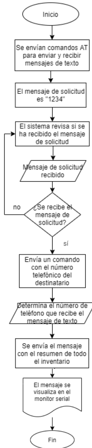
Figura 3.13 Diagrama de bloques para mensajes de solicitud de inventario
