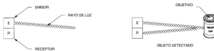
Figura 1.2 Funcionamiento del sensor reflectivo [2]
