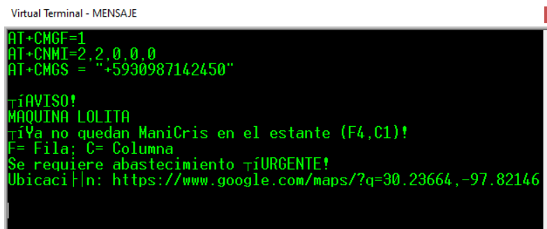
Figura 3.28 Envío de mensaje 2 estante de la fila 4 y columna 1 no tiene productos
