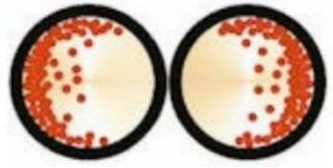
Figura 1.29. Efecto proximidad en los conductores cercanos [17]
