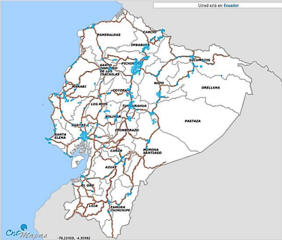
Figura 3.15. Red GPON en el Ecuador [58]
