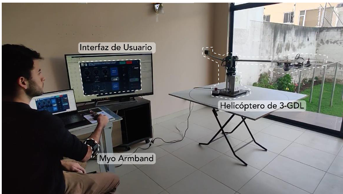
Figura 3.19. Elementos del sistema para control del helicóptero de 3-GDL mediante gestos.
