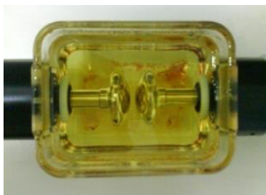
Figura 3. 34. Disposición de los electrodos para la prueba de voltaje de ruptura.
