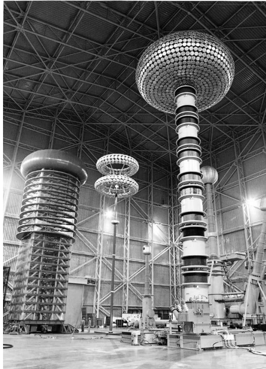
Figura 1.7. Circuito resonante en serie (Laboratorio de investigación Hitachi, Suministrado por Hipotronix, Brewster, USA) [6]
