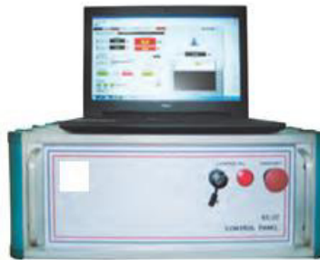
Figura 3. 5. Unidad de control del sistema resonante [25]
