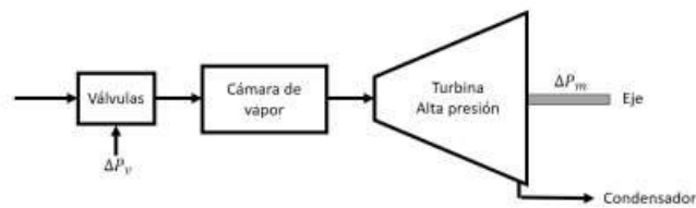
Figura 1.37. Esquema de una turbina térmica sin recalentamiento
