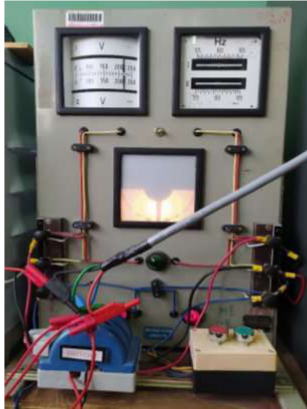
Figura E.20. Sincronoscopio cuando el generador sincrónico y la red se encuentran funcionando en paralelo.
