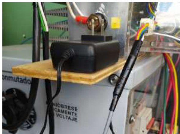
Figura 2.51. Conexión de alimentación y encoder del GOV
