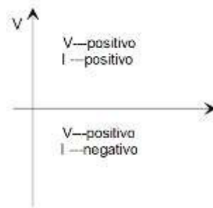
Figura 1.32. Cuadrantes de operación del rectificador trifásico controlado de seis pulsos.
