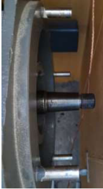
Figura 2.44. Estado inicial de la Armadura y eje de la Máquina Motriz
