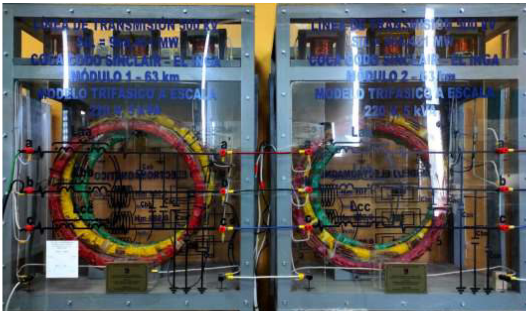
Figura 1.14. Línea de transmisión no transpuesta
