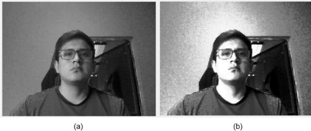
Figura 2.8. Resultado de la ecualización de histograma. (a) Imagen Original. (b) Imagen ecualizada.
