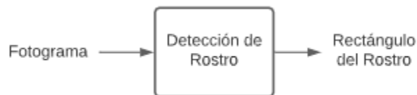
Figura 2.10. Entrada y salida de la etapa 2. La entrada es el fotograma capturado y procesado de la etapa 1 y la salida es el rectángulo detectado donde se encuentra el rostro.
