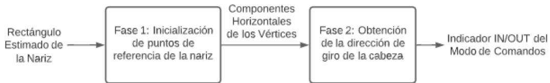
Figura 2.34. Entradas y salidas de la etapa 5. La entrada es el rectángulo de la nariz de la etapa 4 y la salida es un indicador de entrada o salida del modo de comandos.
