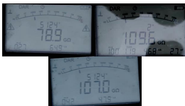
Figura 4.28. Mediciones obtenidas en el megado de cables [Elaboración Propia].
