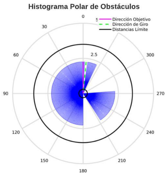
Figura 2.10. Histograma Polar Enmascarado con la dirección de Objetivo y de Giro [Fuente Propia].
