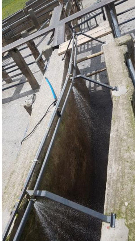
Figura VII.3. Duchas de aspersión para lavado ante-mortem
