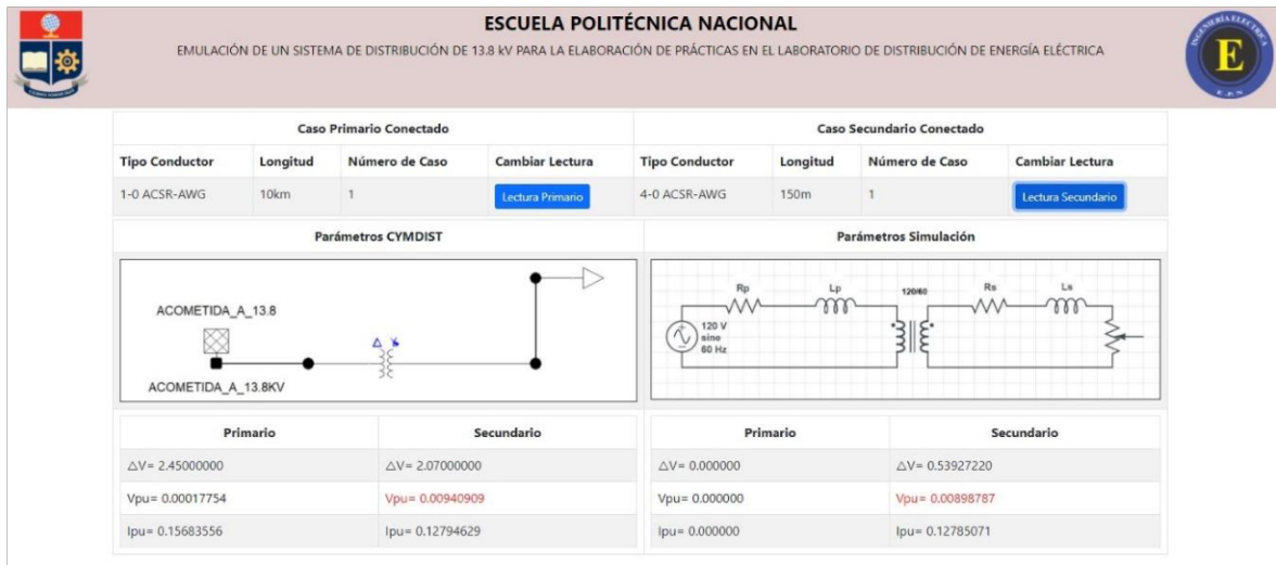
Figura VII.2. Interfaz de resultados caso primario ACSR 1/0 AWG, primer caso secundario, medido en el lado de bajo voltaje.
