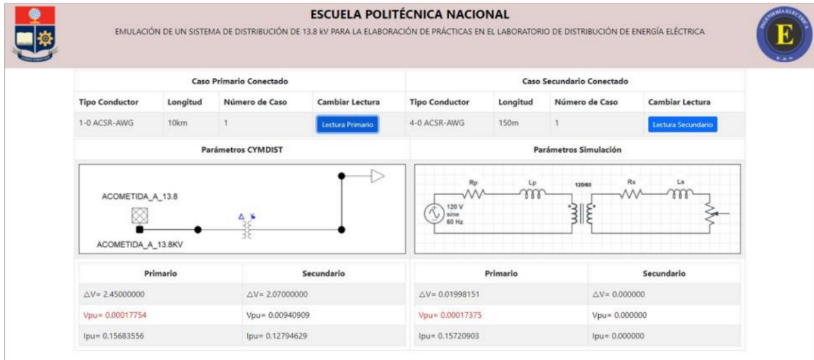
Figura VII.1. Interfaz de resultados caso primario ACSR 1/0 AWG, primer caso secundario, medido en el lado de medio voltaje.
