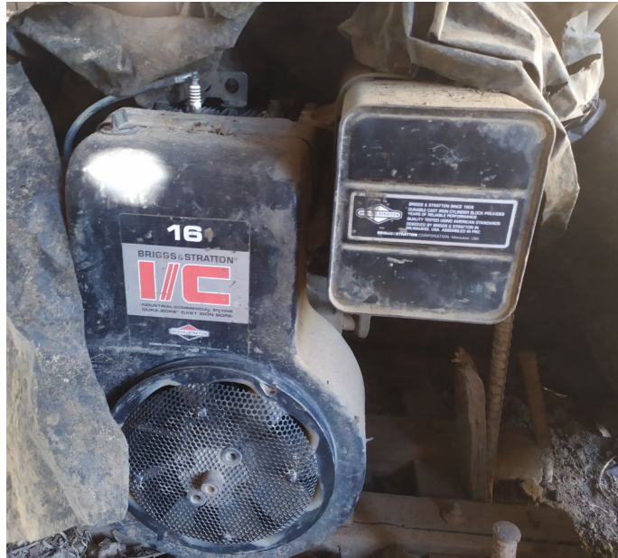
Figura 2.5. Motor Briggs & Statton de 16HP para funcionamiento de mezcladora. Fuente: Propia
