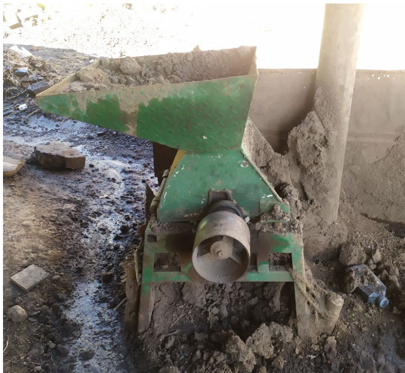
Figura 2.4. Mezcladora de arcilla y tierra Fuente: Propia
