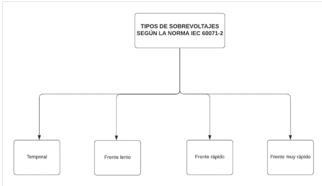
Figura 1.1. Clasificación de los sobrevoltajes según la norma IEC 60071-2. Elaboración propia en base a [1].
